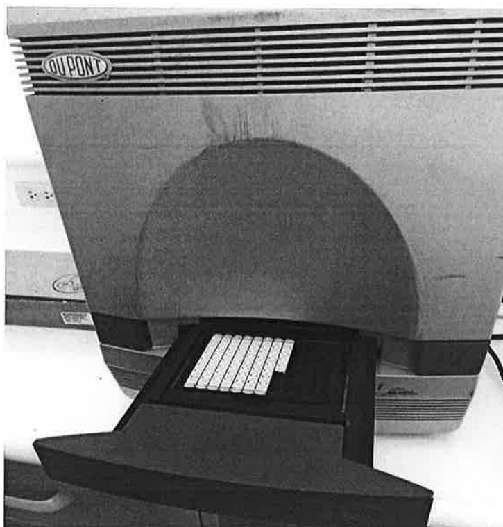
Figura 10. Colocación de muestras en bandeja de termociclador
