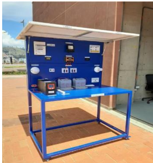
Figura 1: Banco de pruebas para sistemas solares fotovoltaicos
