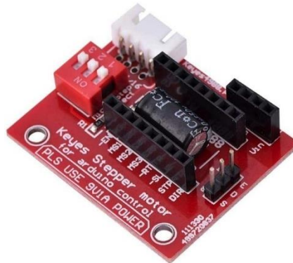
Figura 14: Módulo de extensión para controlador A4988
