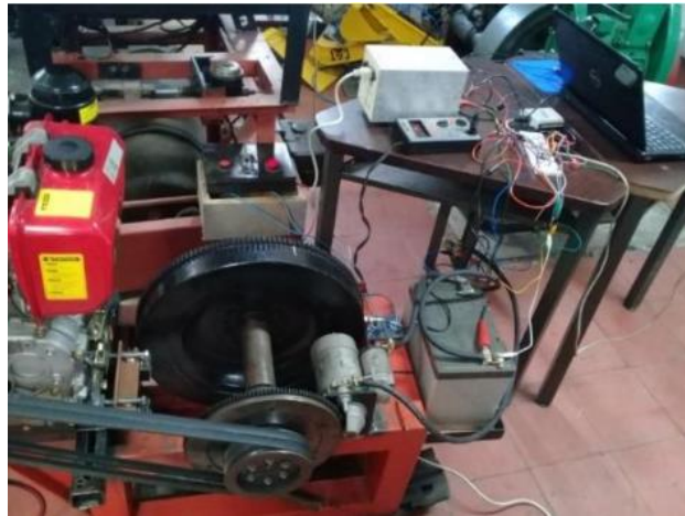
Figura 2: Banco de pruebas para motores de combustión interna
