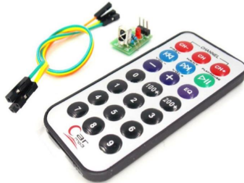
Figura 16: Sensor infrarrojo KY-022 y Control
