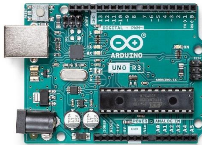
Figura 11: Placa Arduino UNO R3
