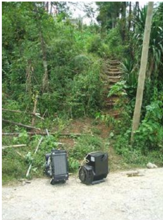
Ilustración 15: Motor del motogenerador al principio del sendero, peso aproximado 750 kg
