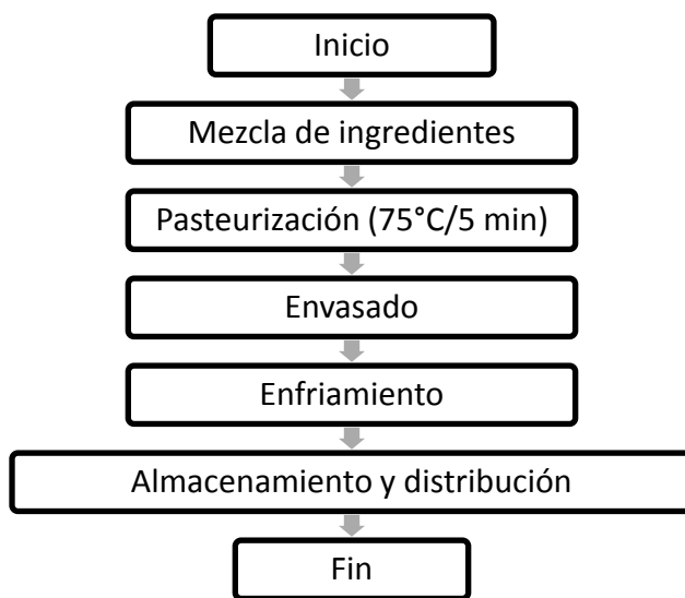
Diagrama 2 Proceso de elaboración de bebida funcional rehidratante
