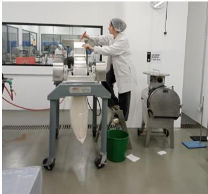
Figura 28. Proceso de molienda del banano deshidratado
