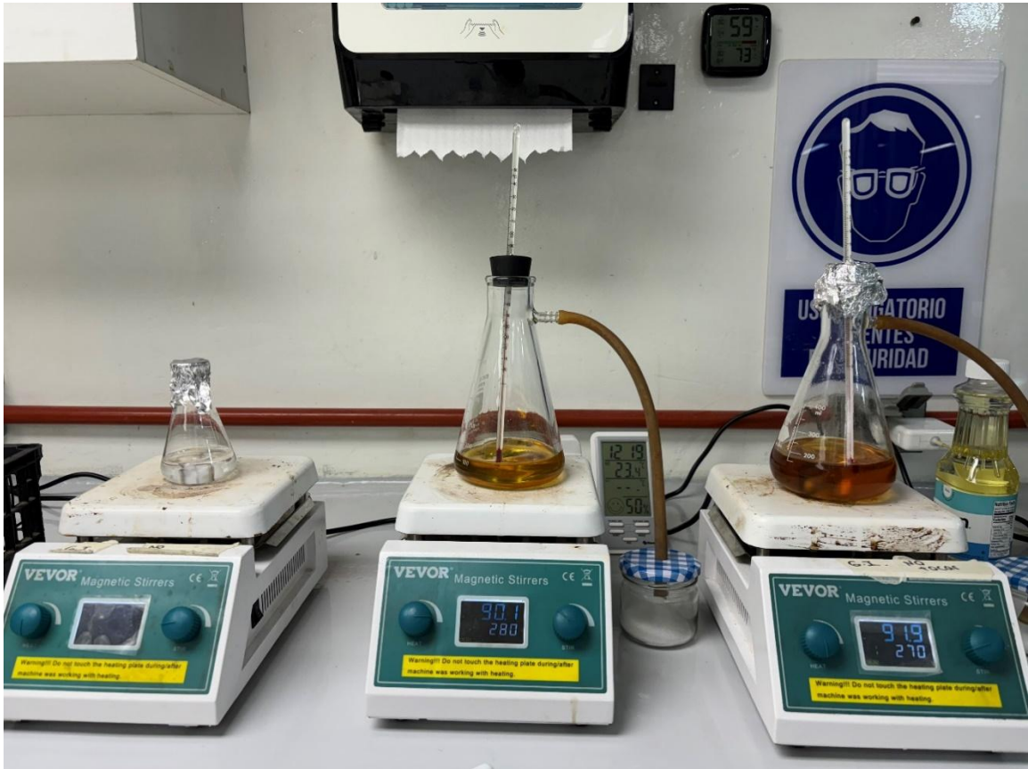
Figura 43. Sistema empleado para la producción de biodiésel a escala laboratorio con etanol y metanol
