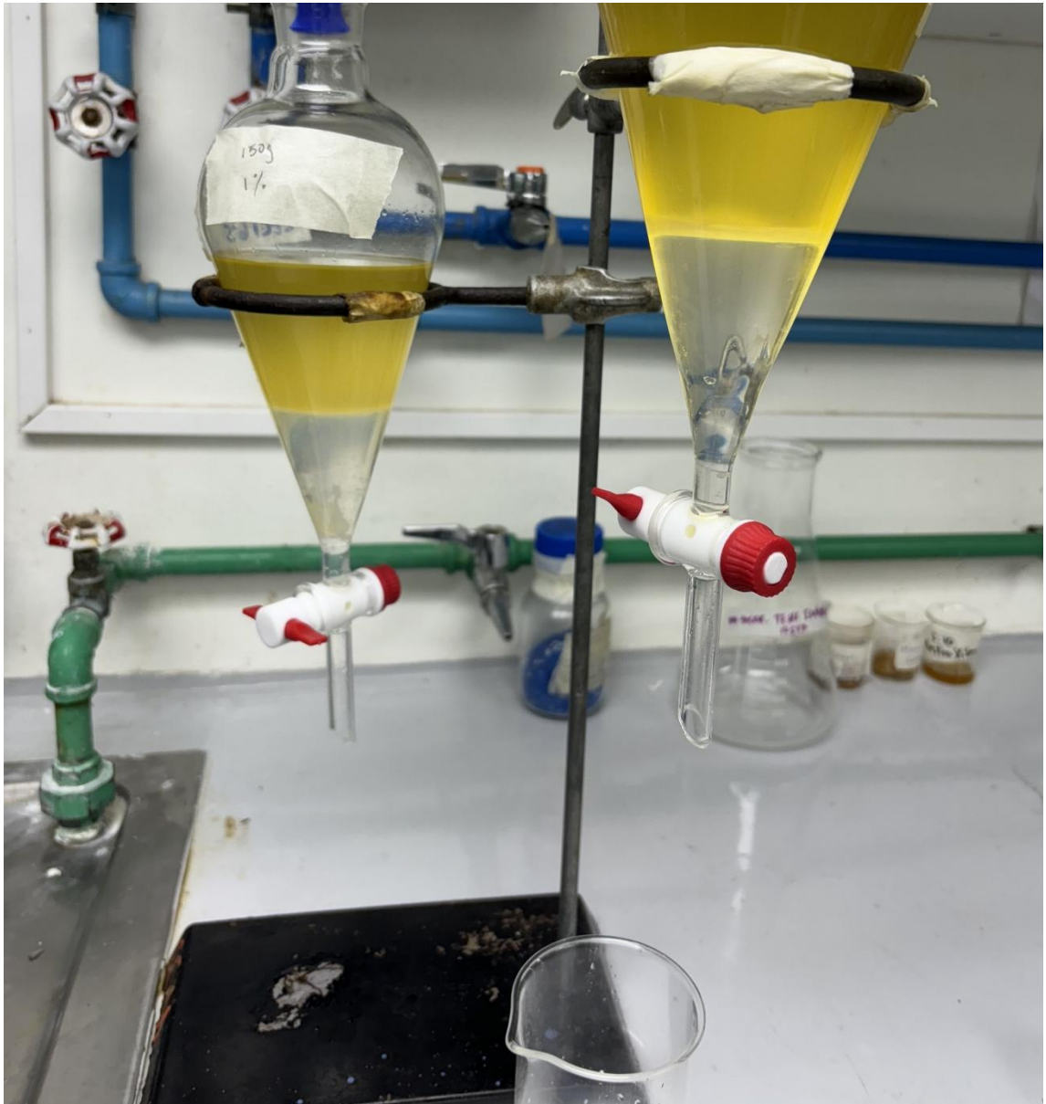
Figura 42. Lavado del biodiésel con etanol utilizando agua destilada y cloruro de sodio
