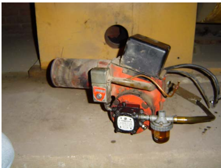
Figura 13. Bomba de diesel
