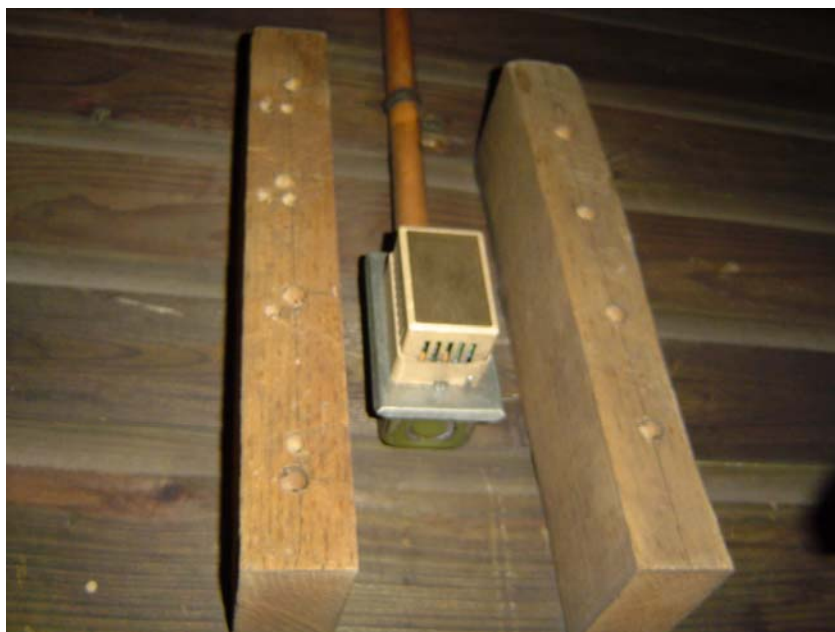
Figura 11. Sensores de temperatura y humedad relativa dentro de cámara de secado
