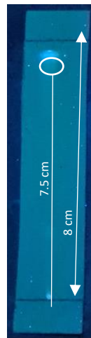
Figura 199. Prueba de TLC para Ganoderma sp. 1 en cloroformo.
