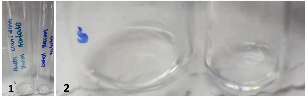
Figura 128. Prueba de cianidinas para Stereum sp. en acetato de etilo.
