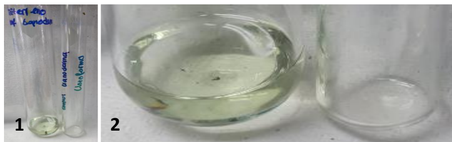
Figura 200. Prueba de triterpenos para Ganoderma sp. 1 en cloroformo.
