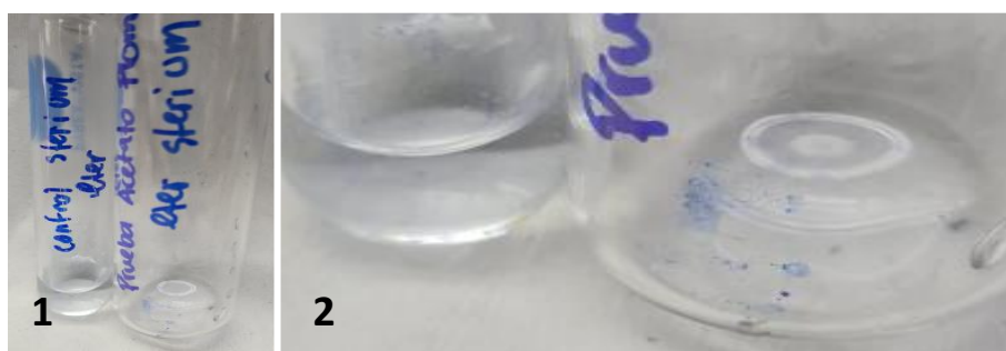
Figura 170. Prueba de acetato de plomo para Stereum sp. en éter de petróleo.
