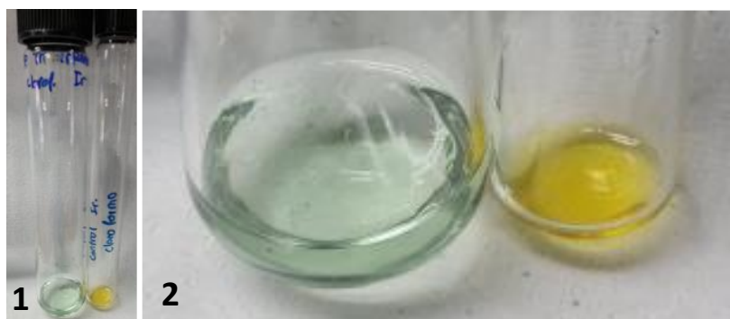
Figura 203. Prueba de triterpenos para Ganoderma sp. 2 en cloroformo.
