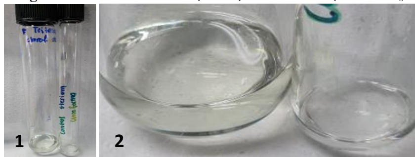
Figura 206. Prueba de triterpenos para Stereum sp. en cloroformo.
