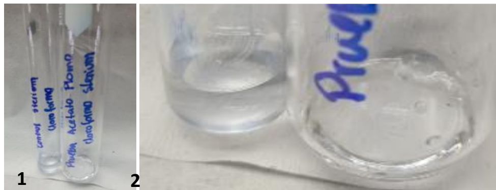
Figura 158. Prueba de acetato de plomo para Stereum sp. en cloroformo.
