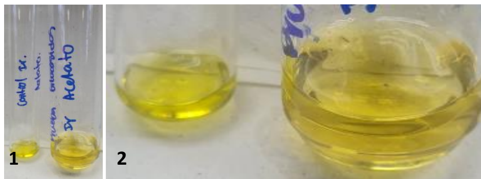
Figura 273. Prueba de glicósidos cardiotónicos para Ganoderma sp. 2 en acetato de etilo.
