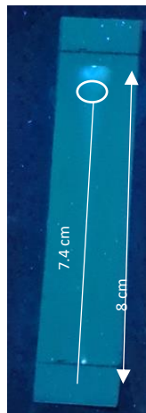
Figura 205. Prueba de TLC para Stereum sp. en cloroformo.
