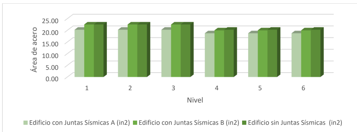
Figura 22. Comparación del refuerzo de columnas céntricas.
