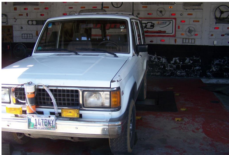
Figura 7.20. Instalación de celda en la parte delantera del vehículo así como vista del sistema de seguridad
