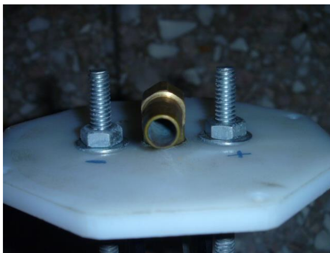
Figura 7.10. Detalle de tornillos y codo de cobre unidos a tapa de polímero
