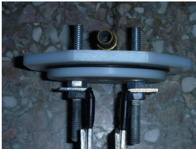
Figura 7.14. Detalle de unión entre electrodos y tirantes.
