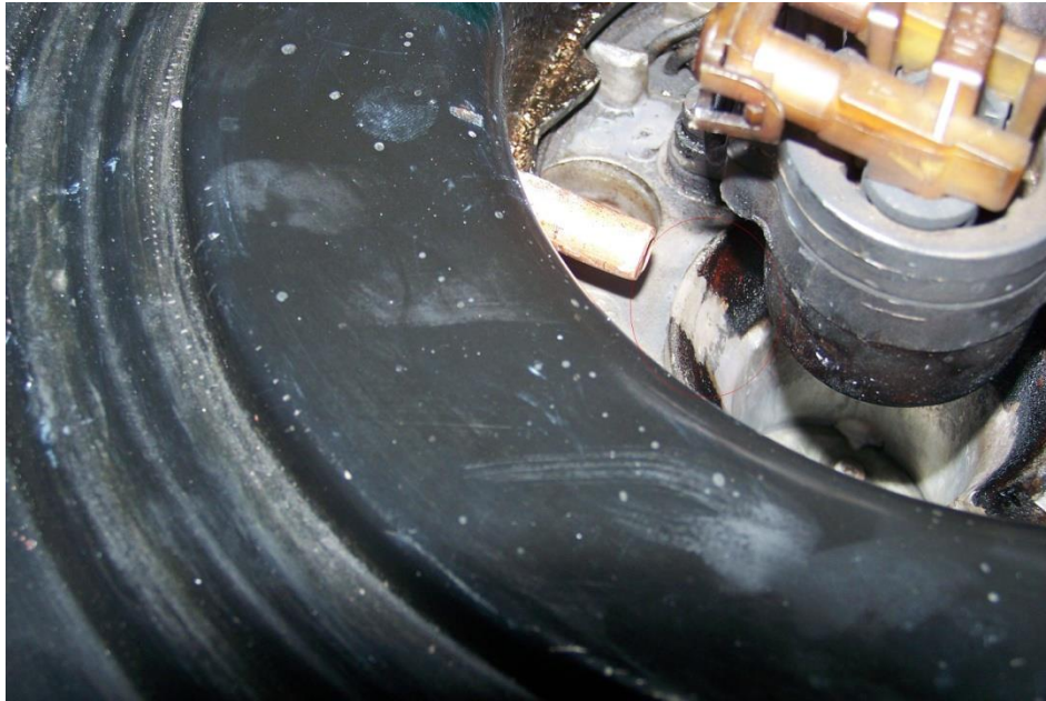
Figura 12.2. Limpieza de depósitos de carbono en garganta de inyector.
