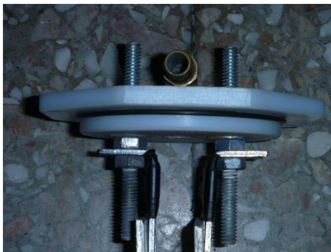
Figura 7.10. Detalle de tornillos y codo de cobre unidos a tapa de polímero
