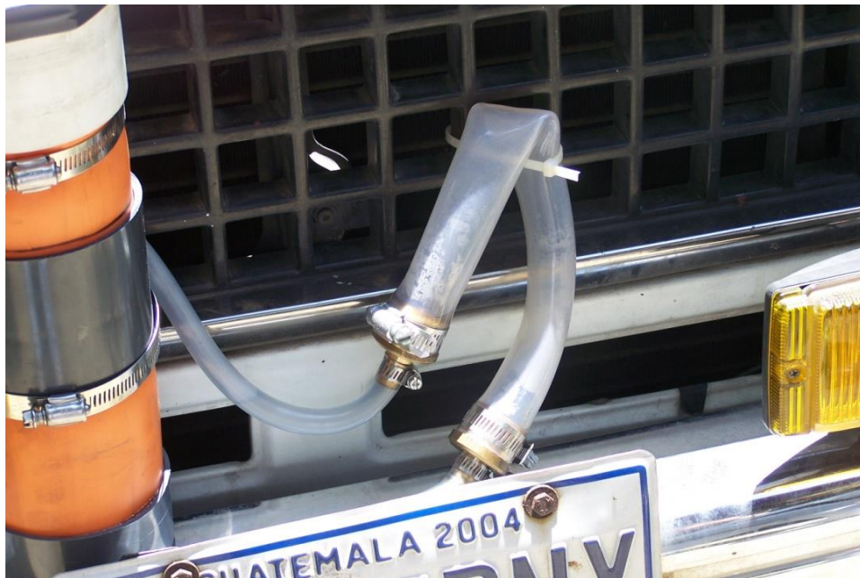
Figura 7.28. Deformación presentada en la trampa de agua después de calentamiento
