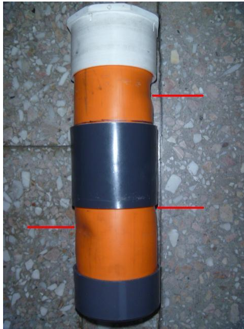
Figura 7.28. Deformación presentada en la trampa de agua después de calentamiento
