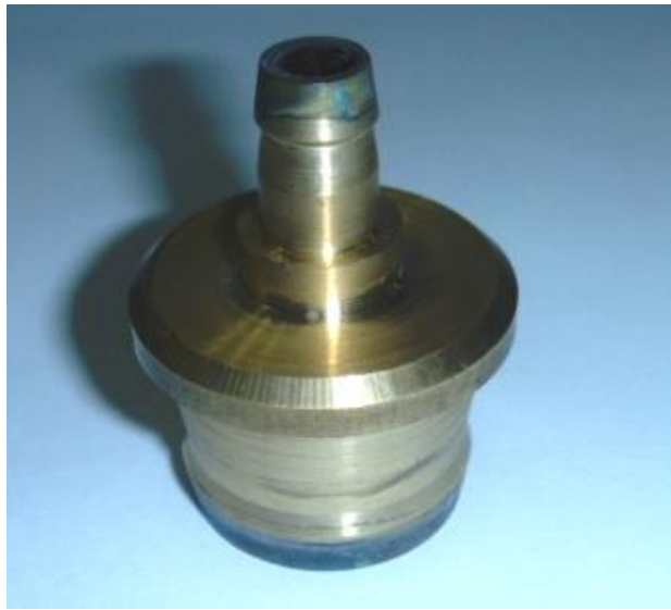
Figura 7.12. Descripción de la brisca reducción que existe en el fitting.
