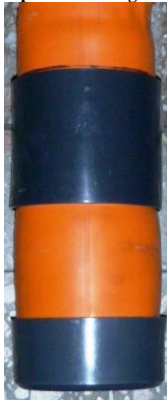
Figura 7.1. Secciones de PVC de 15cm y 3" de diámetro (secciones color naranja) unidas entre sí por una unión para PVC (sección media de la carcasa), en la parte inferior se muestra un tapón pegado para evitar fugas
