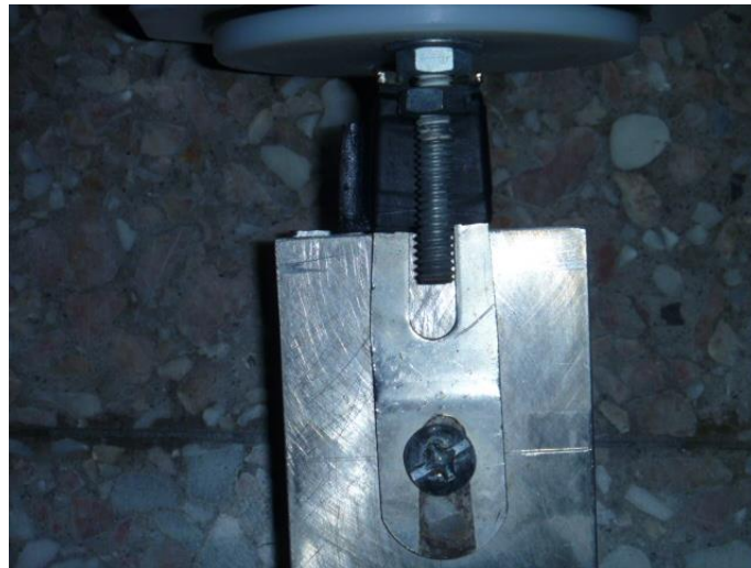
Figura 7.3. Detalle de platina sujeta a electrodo y tirante de acero inoxidable para sujetar a electrodo
