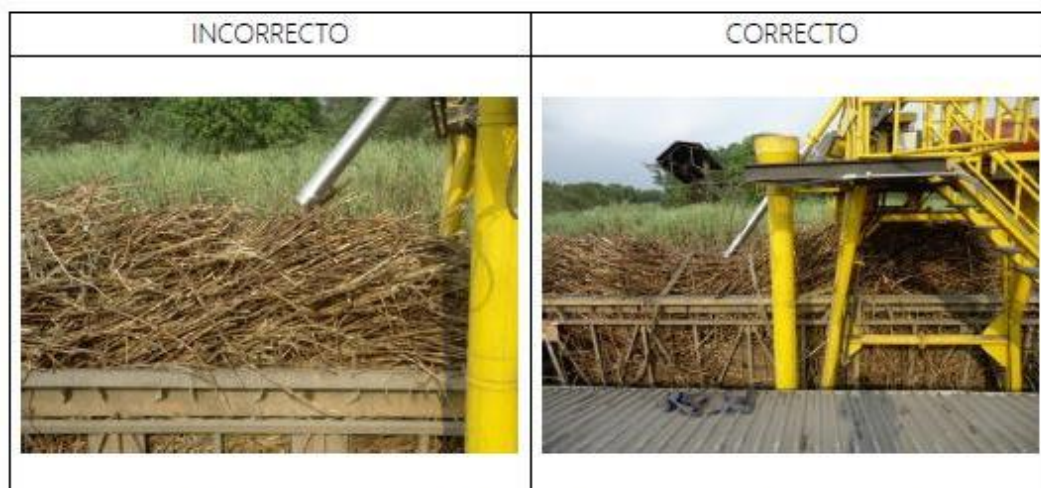
Figura 1. Alineación de los tallos de caña dentro de las jaulas al momento del muestreo
