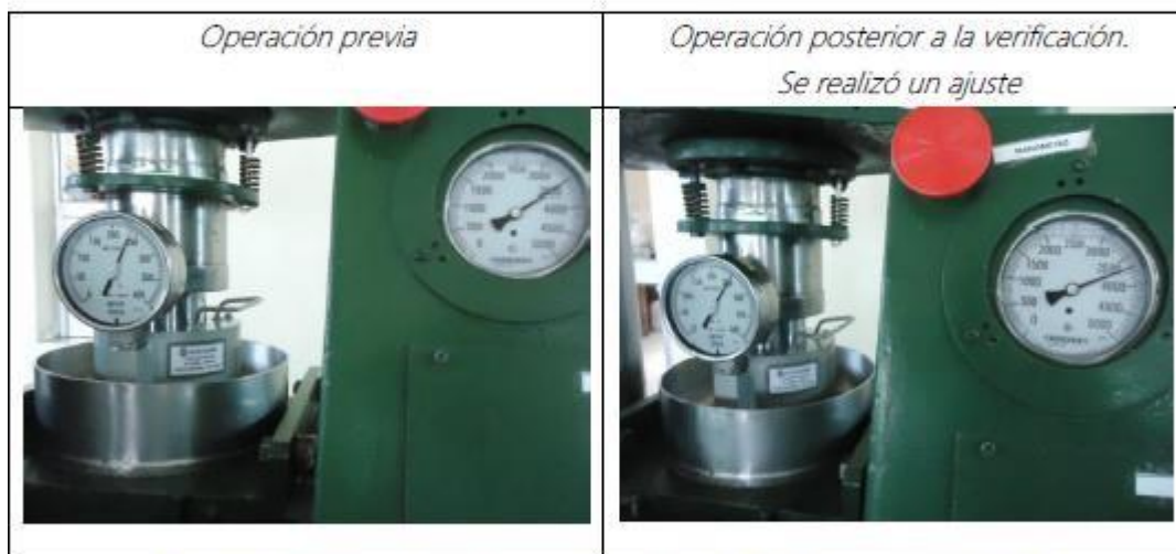
Figura 7. Calibración y ajuste de manómetro de prensa utilizando una celda de carga
