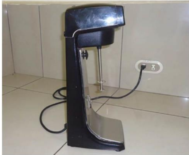
Figura No.32. Homogenizador de muestras de jugo para el análisis de de polarimetría
