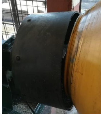
Figura No.30. Ejemplo de mala posición del sello en el sistema de desfibrado y mezclado para la preparación de la caña en el laboratorio de patio.
