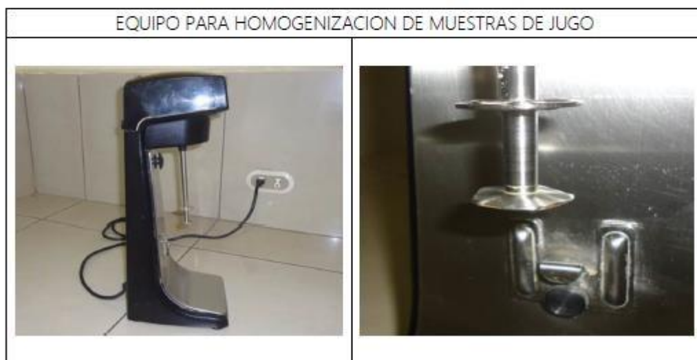
Figura 10. Homogenizadora de muestras y detalle del eje agitador
