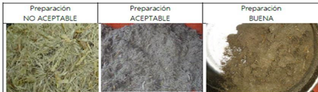
Figura 5. Diferentes niveles de preparación de caña en la desfibadora
