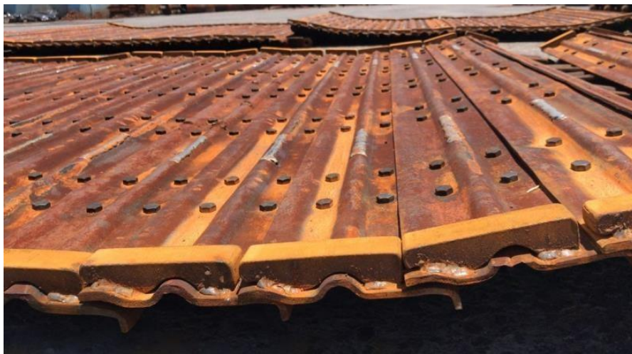
Figura No. 112. Matajuntas en conductores
