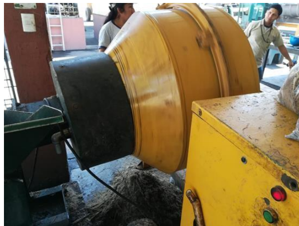
Figura No.29 Sistema de desfibradora y mezcladora para la preparación de las muestras de caña de azúcar obtenidas del Core Sampler y de la alzadora de caña
