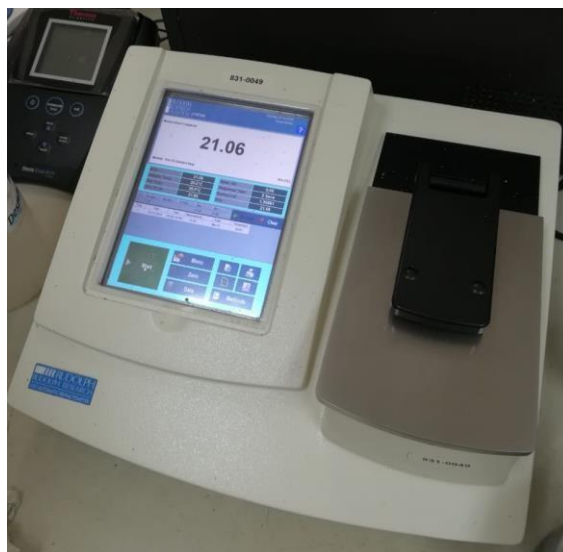
Figura No.33. Equipo refractometría utilizado para obtener el resultado de Grados Brix en las muestras de jugo de caña.
