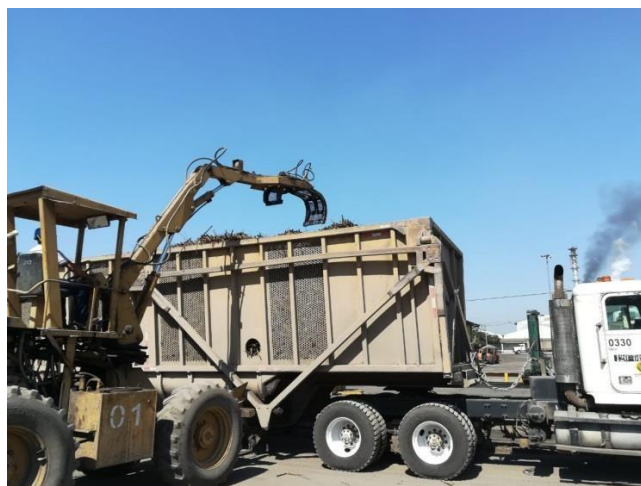
Figura No.27 Alzadora de caña de azúcar empleada para el muestreo en la parte superior de las jaulas de caña de azúcar en el laboratorio de patio.
