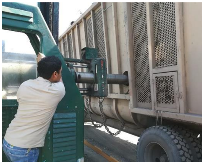
Figura No.26 Equipo de muestreo de sonda horizontal (Core Sampler) para jaulas de caña de azúcar en el laboratorio de patio.
