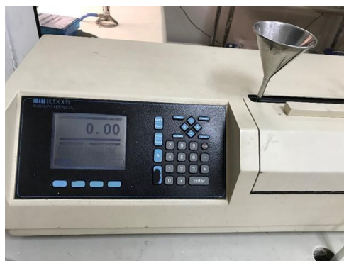
Figura No.34. Equipo de polarimetría utilizado para las muestras de jugo de caña ya clarificado y filtrado.
