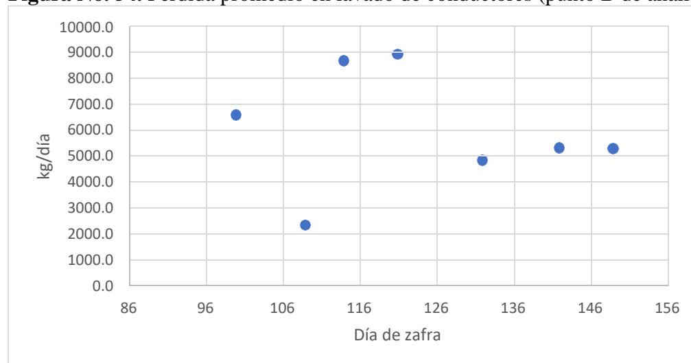
Figura No. 54. Pérdida promedio en lavado de conductores (punto B de análisis).
