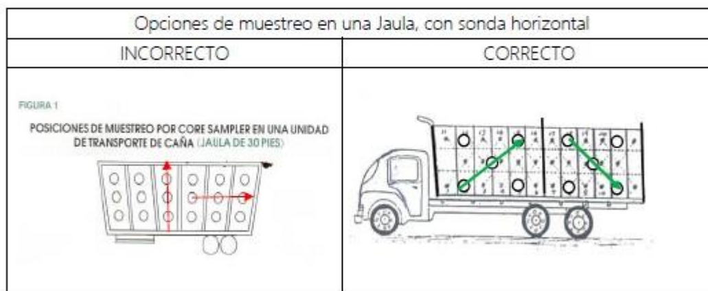
Figura 3. Ubicación de perforaciones en las jaulas con Core Sampler horizontal
