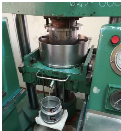
Figura No.31. Prensa hidráulica utilizada en el proceso de prensado para la extracción del jugo de la muestra de caña.
