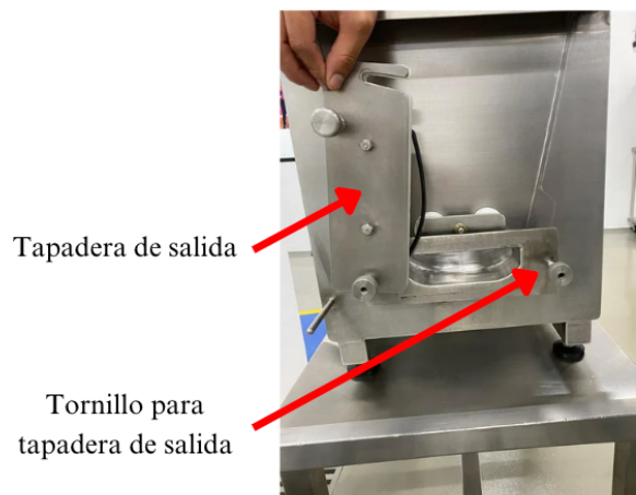
Imagen No.36: Salida de material de la malaxadora de quesos
