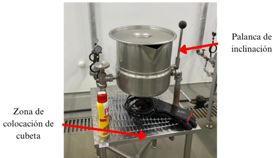
Imagen No.48: Descarga de producto en marmita de vapor
