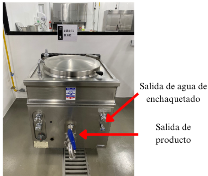
Imagen No.46: Descarga de producto de marmita de gas
