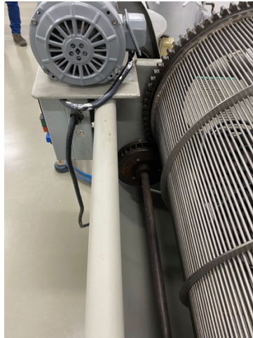
Imagen No.24: Zonas peligrosas del lavador rotatorio
