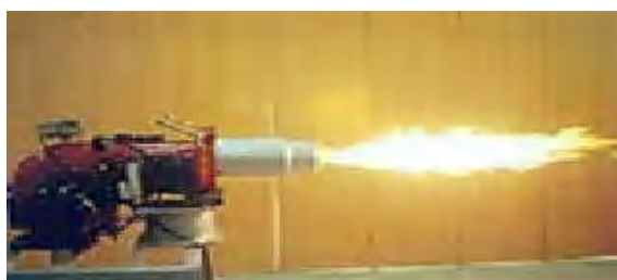
Fig.14 Prueba de llama de un quemador
