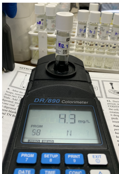
Figura 34: Colorímetro HACH del Centro de Procesos Industriales del Departamento de Ingeniería Química utilizado para la cuantificación de nitrógeno y fosfatos de las muestras de la fermentación de suero de leche por B. subtilis
