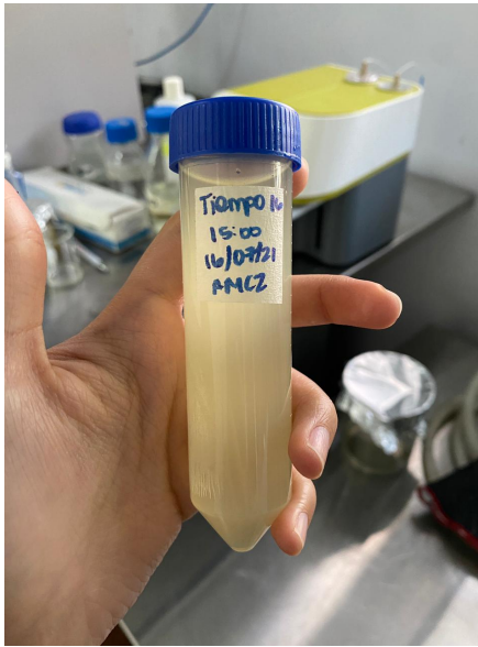
Figura 29: Muestra de 50 mL tomada de la fermentación de suero de leche cocido por B. subtilis a escala de 10L a razón molar C:N de 15:1, a pH inicial de 7.1, 37°C y 200 rpm y a presión atmosférica de 0.844 atm.
