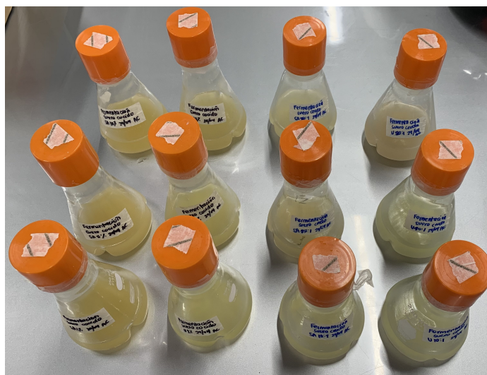
Figura 27: Fermentaciones de suero de leche por B. subtilis a 80 mL para evaluación de efecto de relación molar C:N en el rendimiento de PHA durante 48 h a pH 7.1, 37°C y 200 rpm y a presión atmosférica de 0.844 atm.
