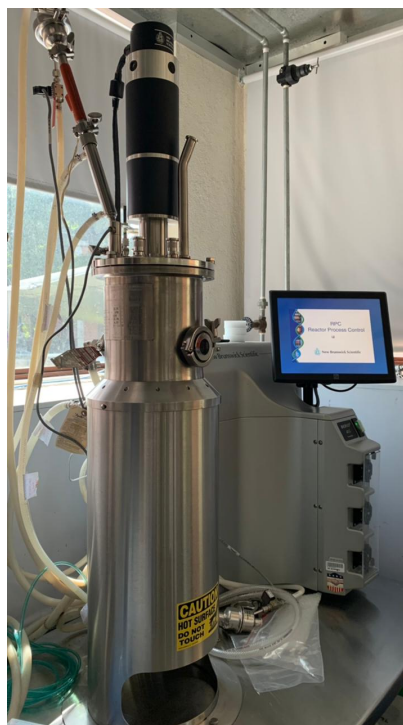
Figura 28: Reactor New Brunswick Scientific BioFlo 415 del Centro de Procesos Industriales del Departamento de Ingeniería Química utilizado para la fermentación de suero de leche por B. subtilis a escala de 10L a razón molar C:N de 15:1 a pH inicial de 7.1, 37°C y 200 rpm y a presión atmosférica de 0.844 atm.
