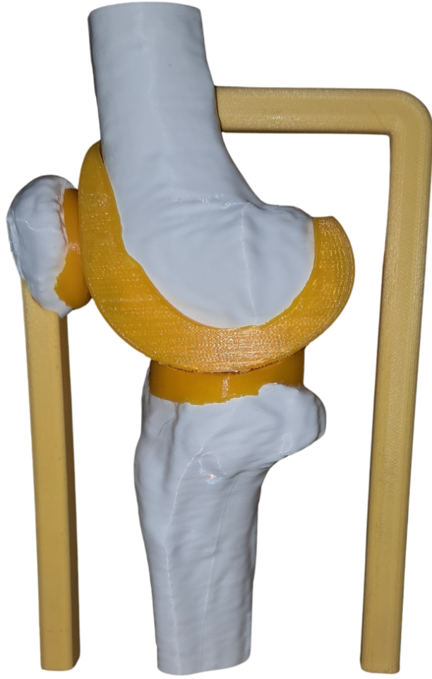
Figura 44. Primera versión de prototipo de prótesis de rodilla personalizada
