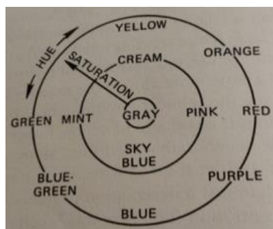
Imagen No. 2: Arreglo de la superficie de los colores en matiz y saturación.
