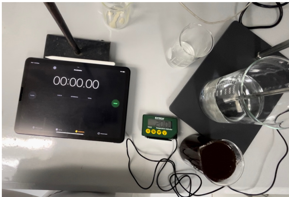
Figura 30. Sistema de reacción experimental para la determinación del calor de reacción
