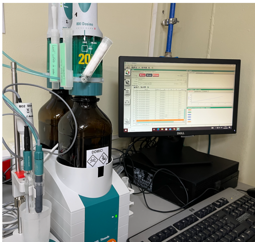
Figura 33. Titando 905 Metrohm y su interfaz para la determinación de la concentración de dodecilbencensulfonato de sodio
