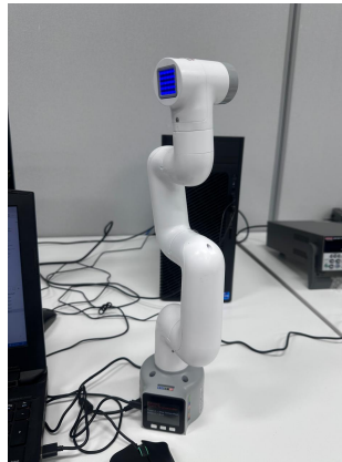
Figura 22. Posición HOME del manipulador MyCobot280.
