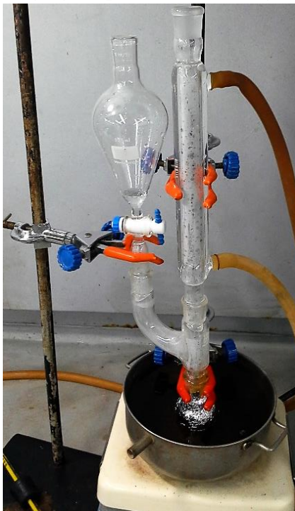
Figura 25. Sistema de reacción. Consiste en un balón de 50mL conectado a un adaptador en Y. Éste a su vez se conecta con un condensador y un embudo de decantación a través del cual se agregó el peróxido de hidrógeno.
