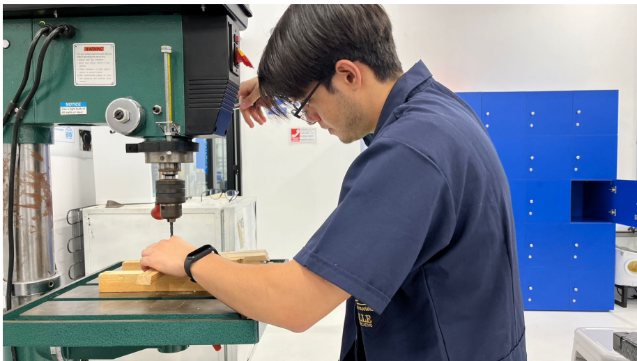
Figura 86: Perforación de agujeros para uniones pernadas
