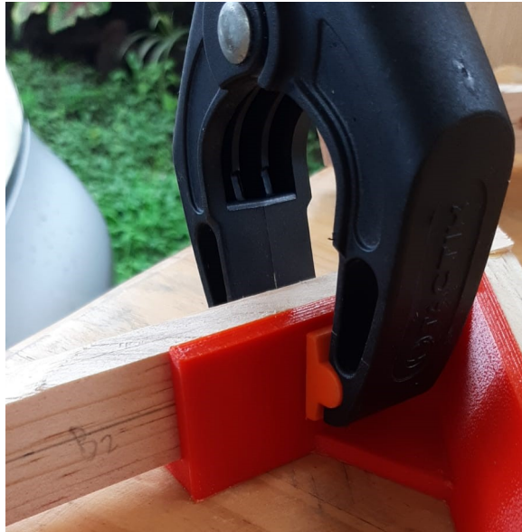
Figura 87: Prensado de varillas para adhesión con pegamento
