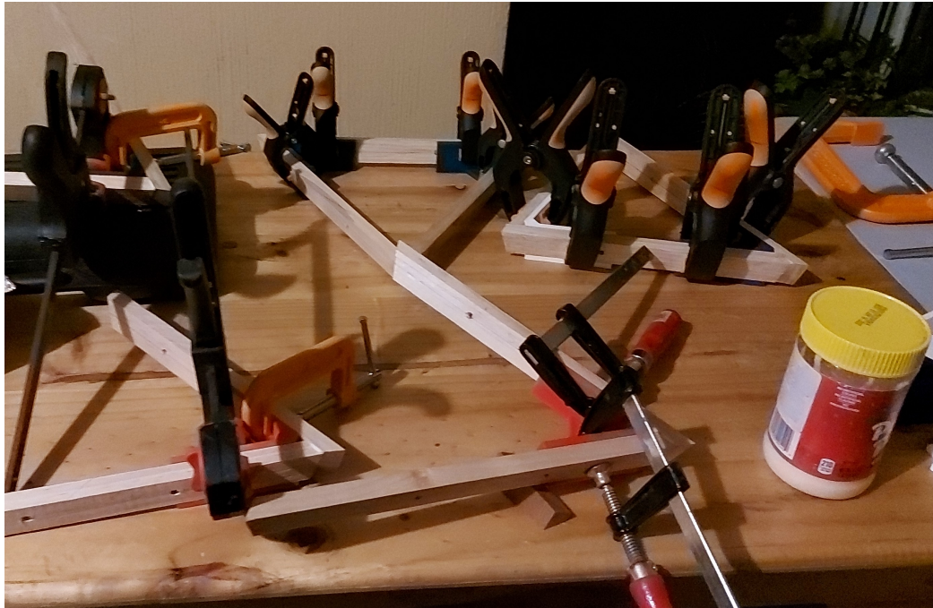
Figura 117: Uso de soportes y prensas para pegado de varillas
