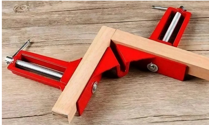
Figura 77: Unión de piezas con prensa esquinera
