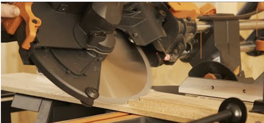
Figura 67: Sierra ingletadora - Corte en bisel
