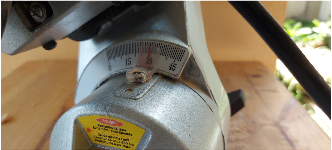
Figura 112: Ajuste de ángulo de bisel - ingletadora
