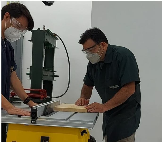
Figura 83: Cortes longitudinales para obtención de varillas con sierra de banco
