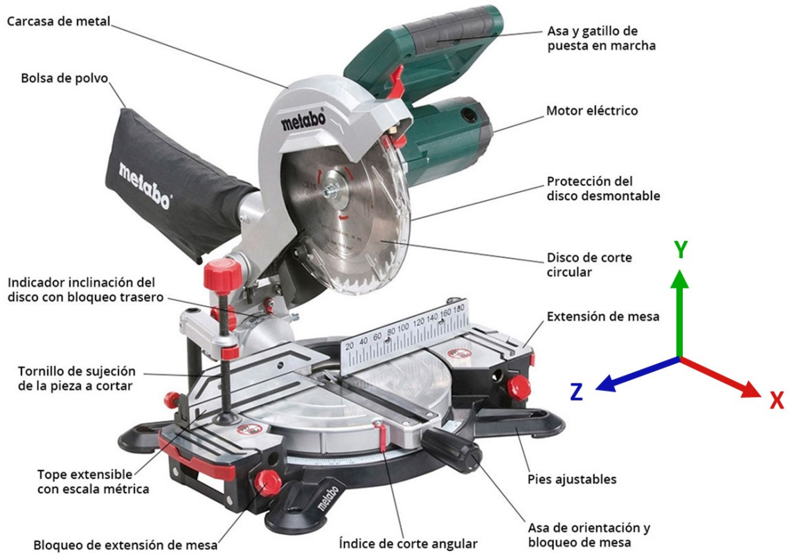
Figura 65: Sierra ingletadora y sus partes
