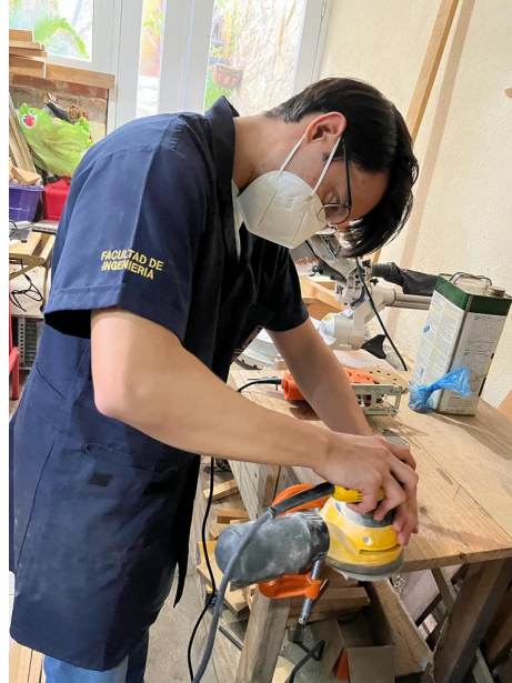
Figura 85: Lijado de varillas para un mejor acabado superficial
