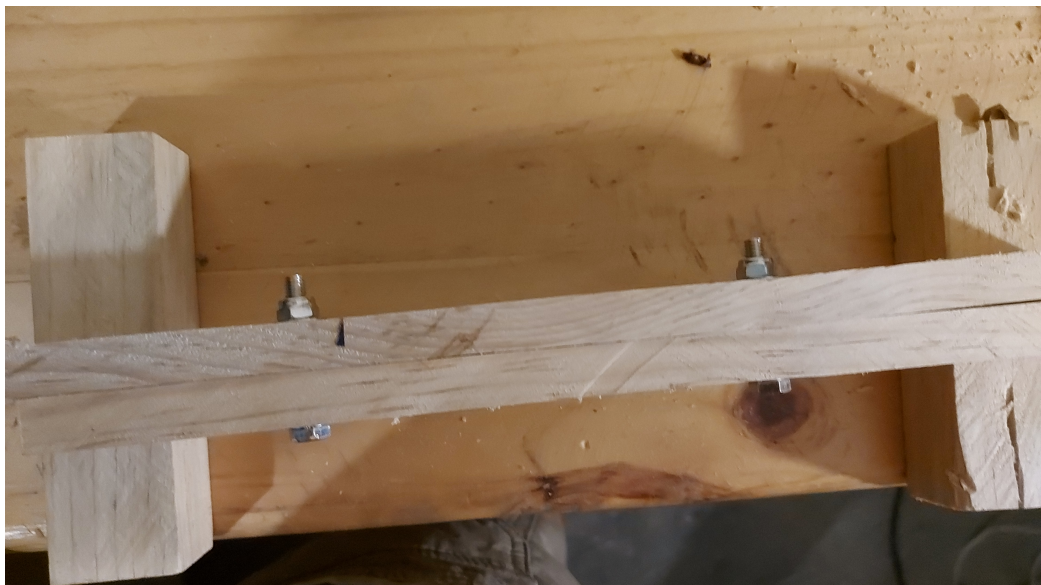
Figura 118: Prueba de perforación de agujeros y ensamble pernado con varillas de prueba
