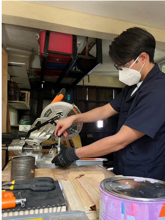
Figura 106: Familiarización con ingletadora - métodos de sujeción de piezas
