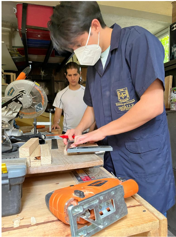
Figura 108: Revisión de ángulos de corte - ingletadora
