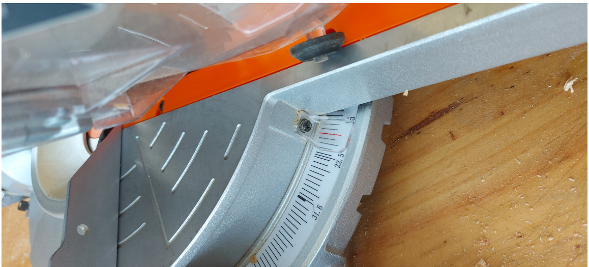
Figura 113: Ajuste de ángulo de inglete - ingletadora
