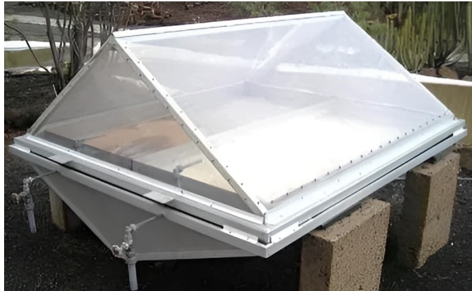
Figura 11: Destilador de vertiente doble
