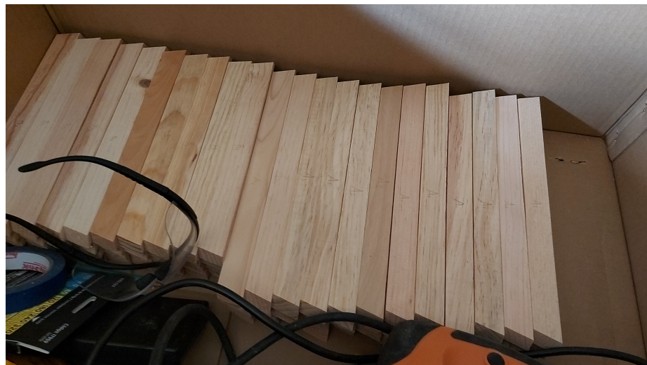
Figura 109: Varillas con longitud y cortes requeridos para perforación
