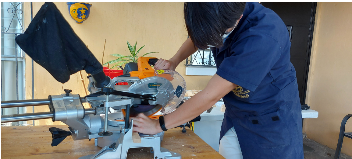
Figura 84: Cortes en inglete y bisel de varillas con sierra ingletadora
