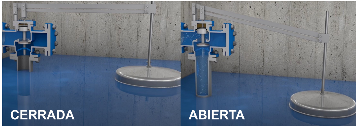
Figura 33: Funcionamiento de válvula flotante, vista seccionada
