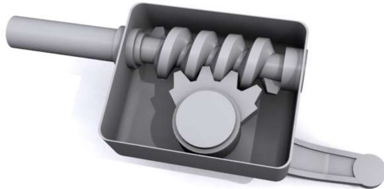
Figura No. 17 Sistema de direccionamiento por tornillo sin fin
