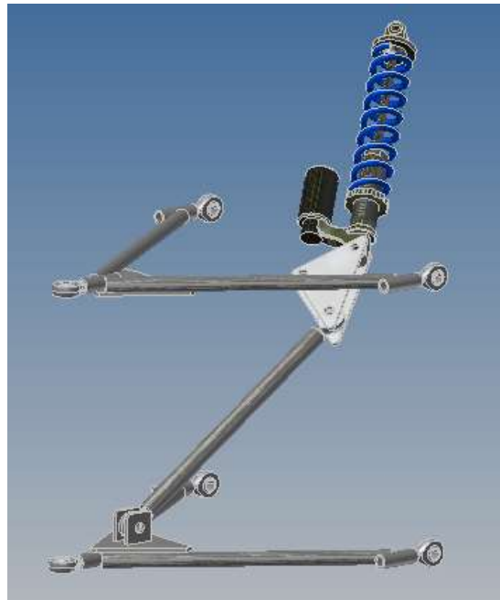
Figura No. 63 Sistema de suspensión para las llantas frontales
