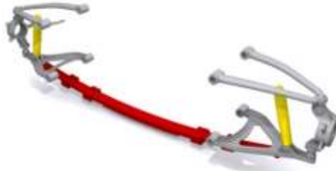
Figura No. 13 Configuración semi-independiente de una suspensión “double wishbone”
