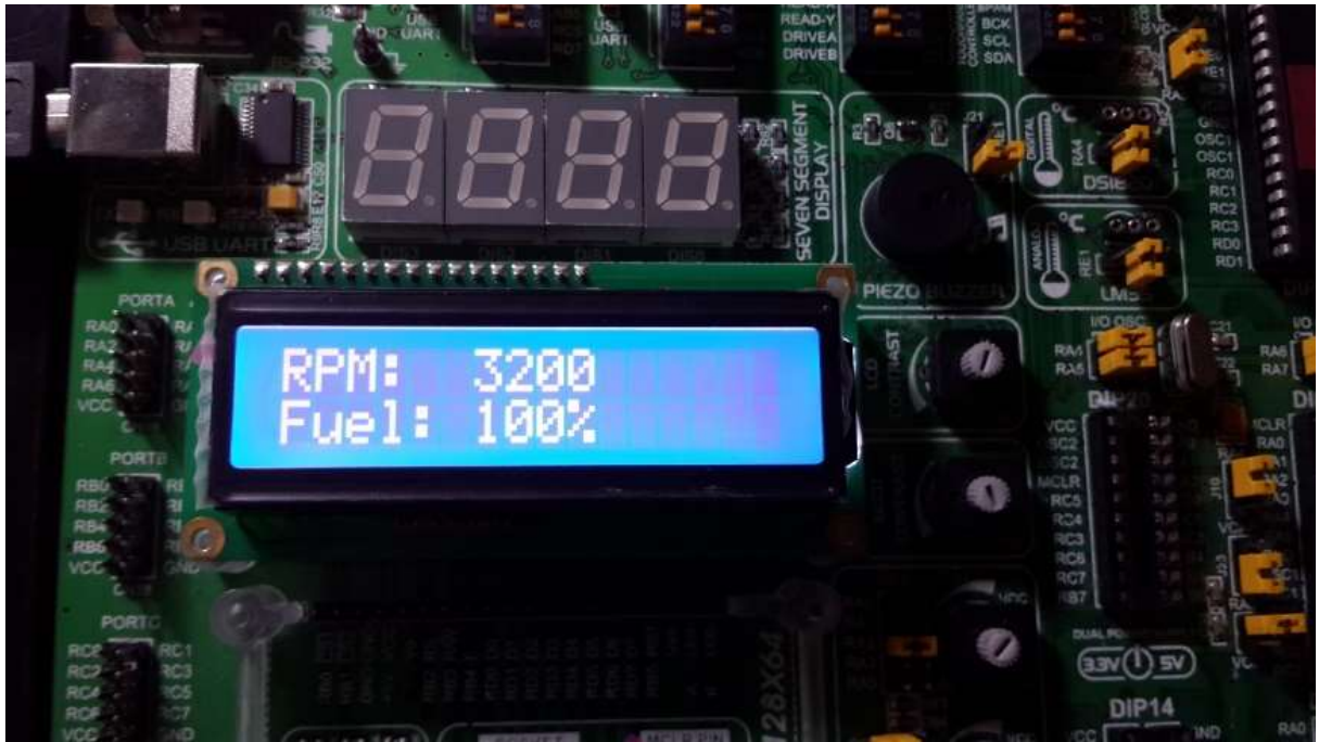
Figura No. 159 LCD del tablero que despliega las RPM del motor y el nivel de combustible.
