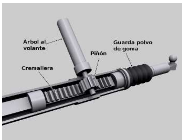
Figura No. 16 Sistema de direccionamiento piñón cremallera
