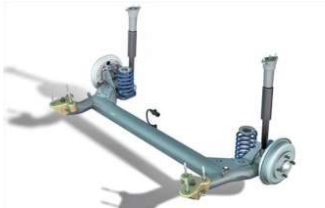
Figura No. 14 Configuración general de una suspensión dependiente
