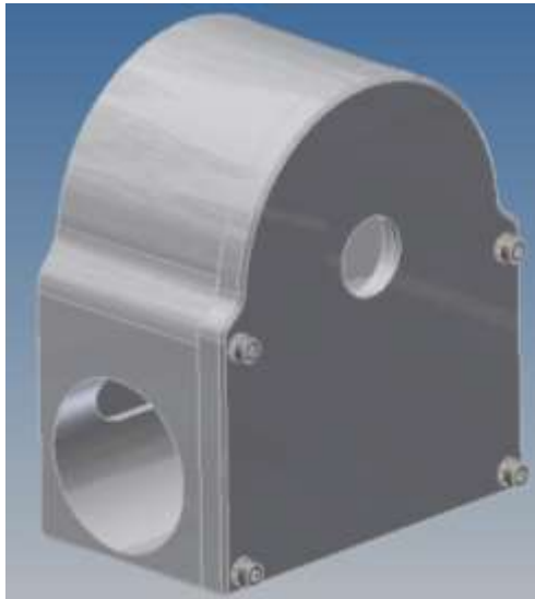
Figura No. 116 Diseño del cajón que sostiene al piñón y la cremallera.
