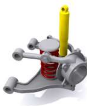
Figura No. 12 Configuración general de una suspensión “Multi-Link”
