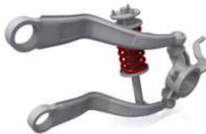
Figura No. 11 Configuración general de una suspensión “Trailing arm”
