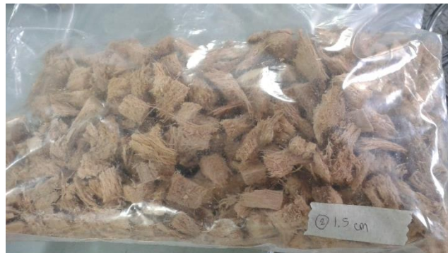
Ilustración 81 - Mesocarpio del coco a un tamaño de partícula de 1.5 cm de diámetro
