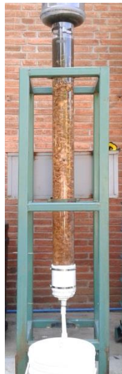
Ilustración 85 - Introducción de primeras aguas al biofiltro a escala planta piloto
