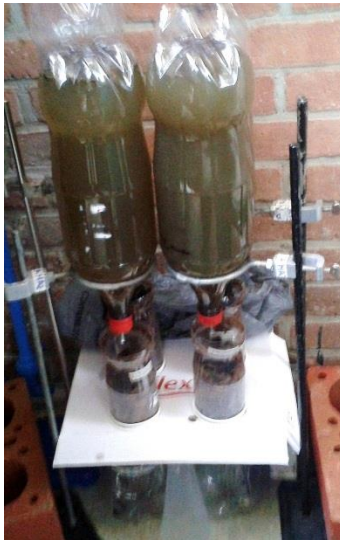
Ilustración 84 - Batería de biofiltros para determinar el mejor tamaño de partícula funcionando
