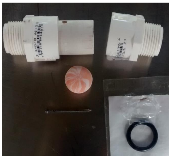
Ilustración 27 - Materiales utilizados para la válvula de cheque
