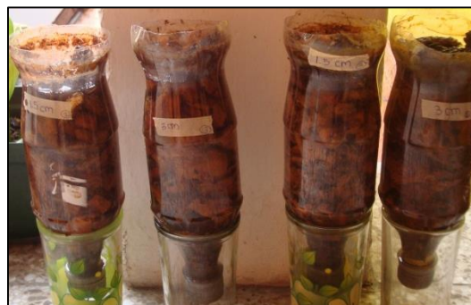
Ilustración 83 - Batería de biofiltros inundados con agua residual a tratar
