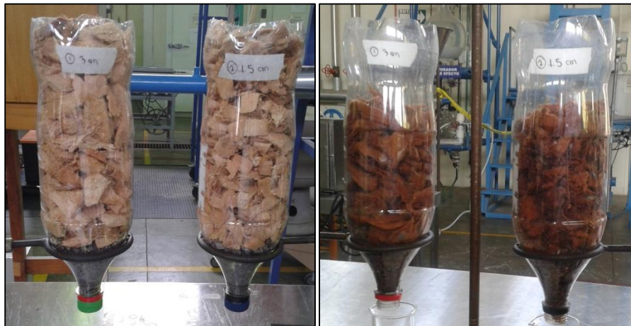
Ilustración 82 - Pruebas preliminares con dos diferentes tamaños de partícula, 1.5 cm y 3 cm.
