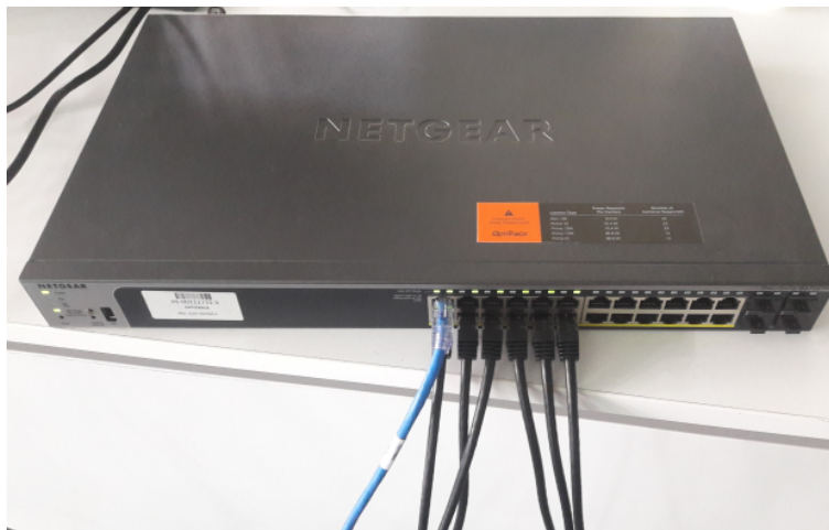
Figura 5: Switch NETGEAR ProSafe GS728TPPv2 y conexión de cámaras (en negro) y computadora (en azul).
