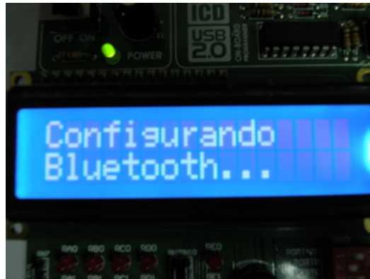
Figura 19: Mensaje desplegado al ejecutar la instrucción SET_EVENT_FILTER.
