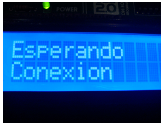
Figura 20: Mensaje mostrado cuando el maestro espera la conexión con el teléfono celular.
