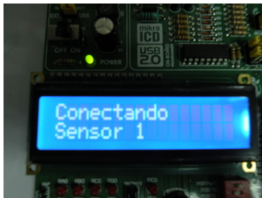
Figura 21: Mensaje mostrado al iniciar la conexión utilizando la instrucción SPP_ESTABLISH_LINK.
