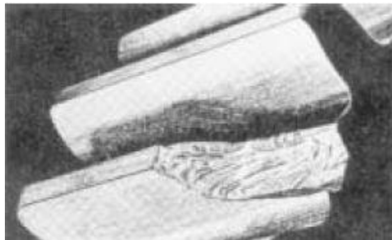
Figura 11. Ruptura por sobrecarga.
