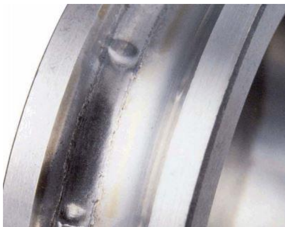
Figura 27. Verdadero Brinelling en el aro interior del rodamiento.
