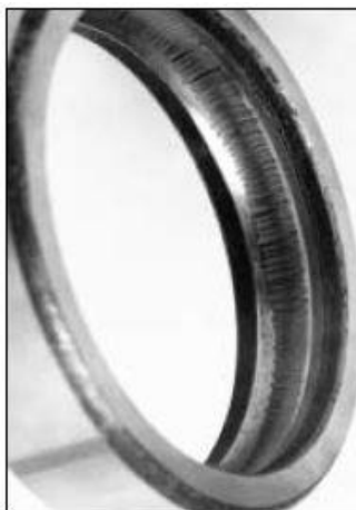
Figura 18. Estrías por paso de corriente eléctrica en aro exterior de rodamiento.
