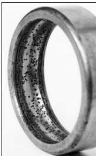
Figura 23. Daños por corrosión en aro exterior de rodamiento de bolas.
