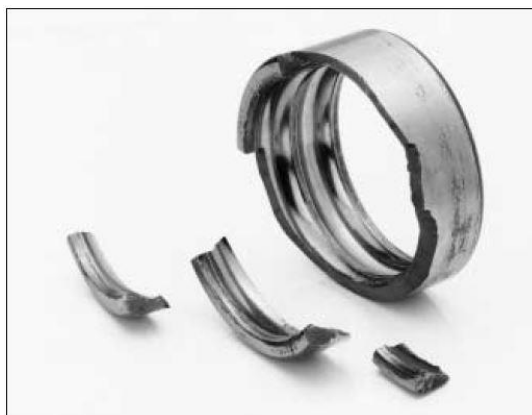
Figura 24. Roturas de aro exterior de rodamiento.
