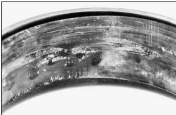
Figura 21. Gripado en superficie de rodadura de aro exterior de rodamiento.
