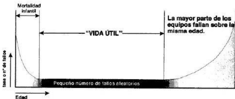
Figura 35. Gráfica de fallos durante ciclo de vida de activos, Curva de la bañera.
