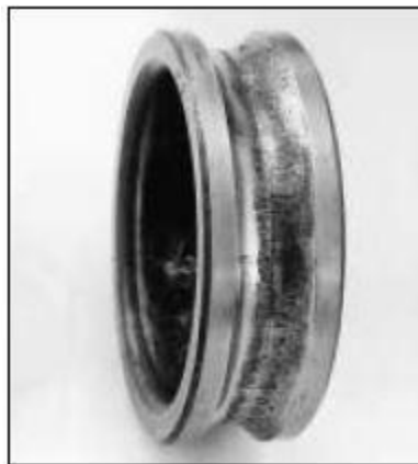
Figura 15. Daños causados por fatiga superficial, picado avanzado o severo en aro interior de rodamiento.
