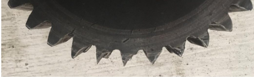
Figura 10. Ruptura por desgaste pesado.
