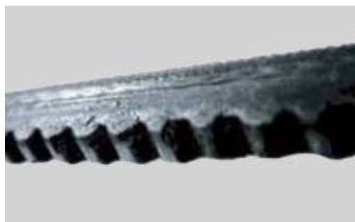
Figura 31. Quemadura en los costado y parte inferior.
