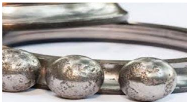
Figura 16. Daños causados por fatiga superficial, picado avanzado o severo en bolas de rodamiento.
