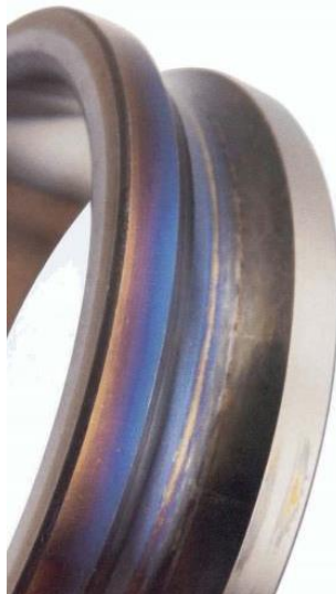
Figura 24. Daños por calentamiento.
