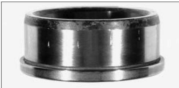
Figura 20. Impresiones producidas por cuerpos rodantes. Estrías longitudinales.
