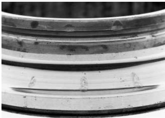
Figura 25. Oxidación de contacto, falso Brinelling en aro interior en rodamiento de bolas.
