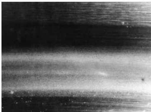
Figura 22. Daños por desgaste en camino de rodadura.
