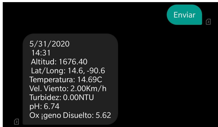
Figura 79: Resultado de cuarto prototipo en agua potable con hielo
