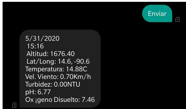
Figura 77: Resultado de cuarto prototipo en aguavirtiéndole aire
