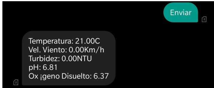
Figura 60: Resultados prueba de envío de mensaje en agua de grifo
