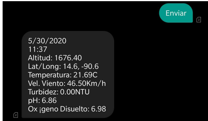
Figura 63: Resultados prueba envío de mensaje con información del GPS
