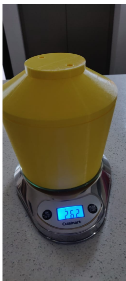
Figura 93: Partes unidas y verificación de peso del quinto prototipo
