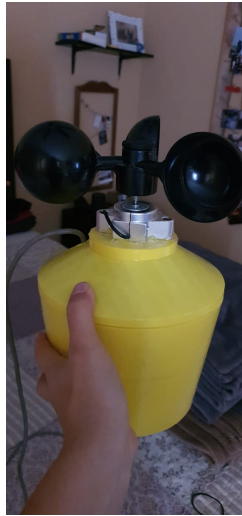
Figura 94: Integración de sensores al quinto prototipo impreso
