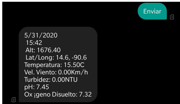
Figura 83: Resultado de cuarto prototipo en agua potable con jabón
