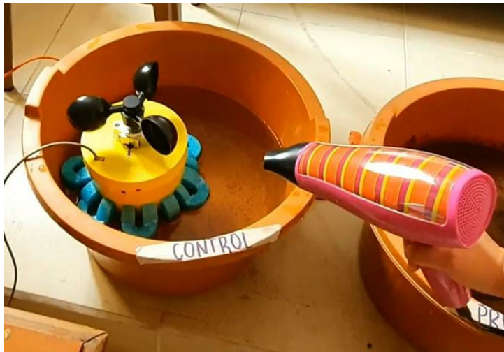
Figura 110: Boya colocada en escenario de control con aire
