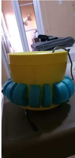
Figura 98: Diseño del sistema final impreso con flotadores
