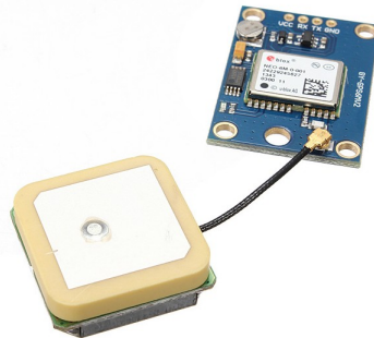
Figura 5: Pines del módulo NEO6M GPS [20]
