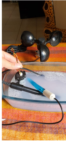
Figura 55: Prueba de pH alto
