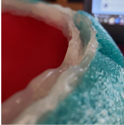
Figura 70: Canal realizado para el acople de la parte inferior con parte superior
