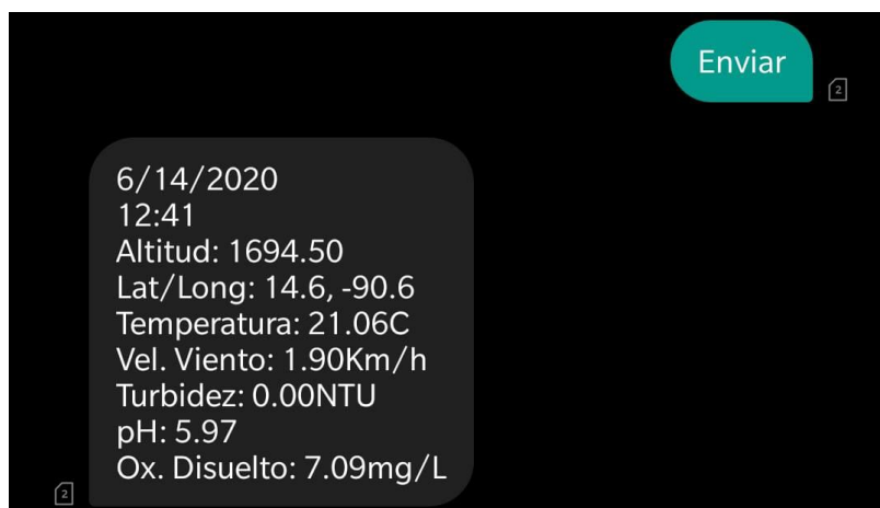
Figura 111: Resultados de boya colocada en escenario de control con aire
