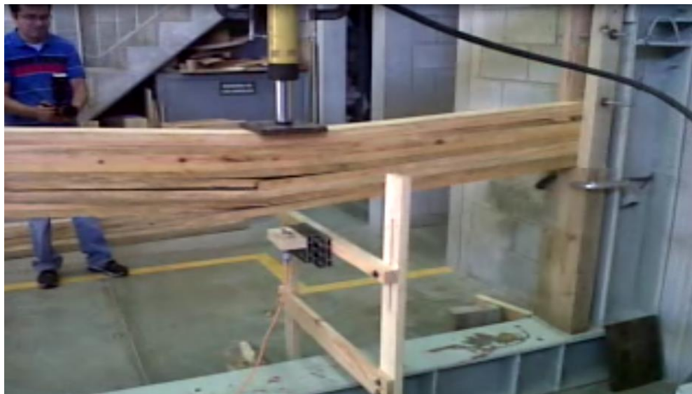
Foto 13 Viga de madera No. 1 fallada
