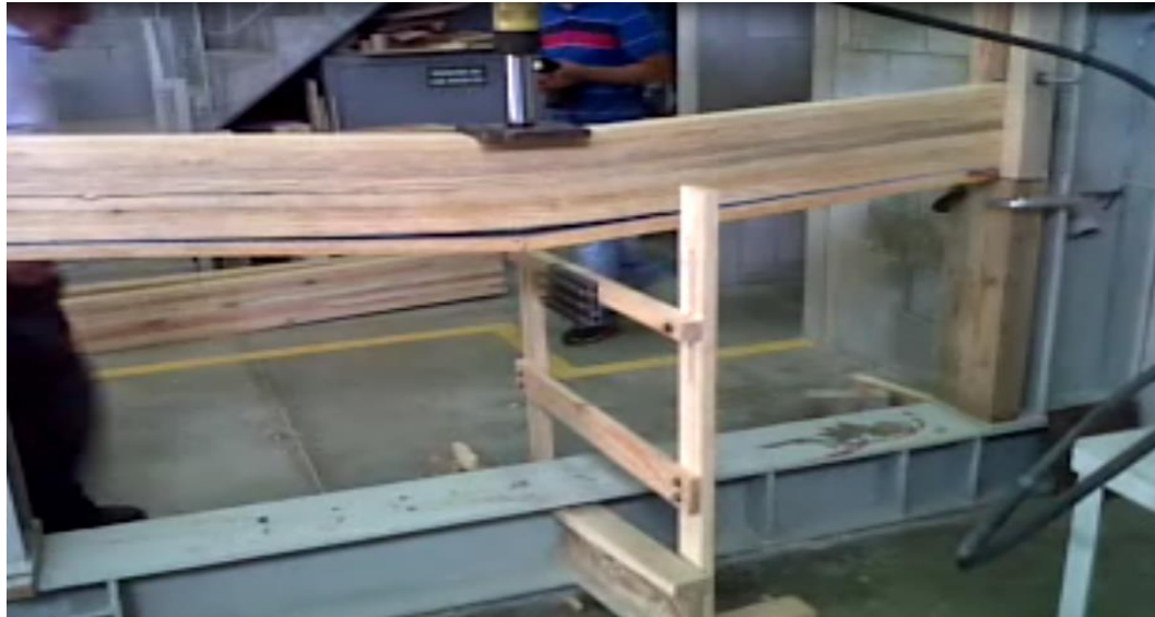
Viga de madera No. 1 fallada
