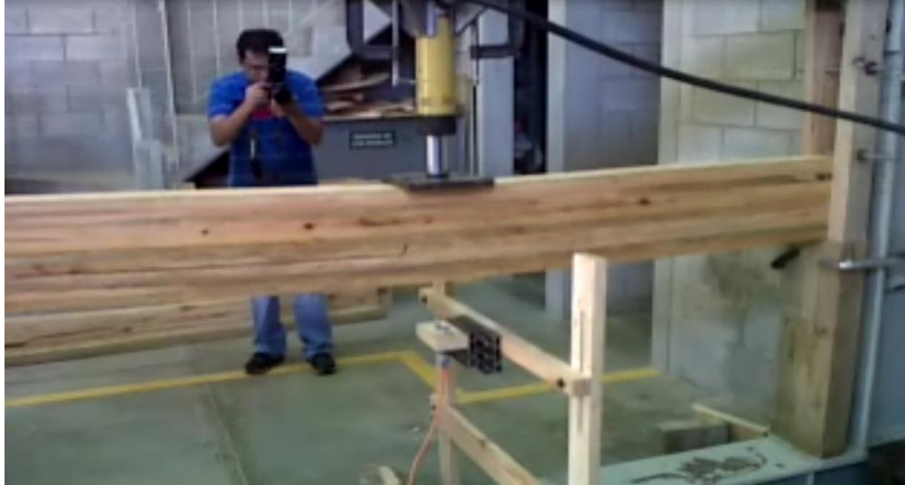
Foto 17 Viga de madera No. 3 fallada
