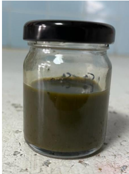
Figura 6: Muestra de digestato (al final de la digestión)
