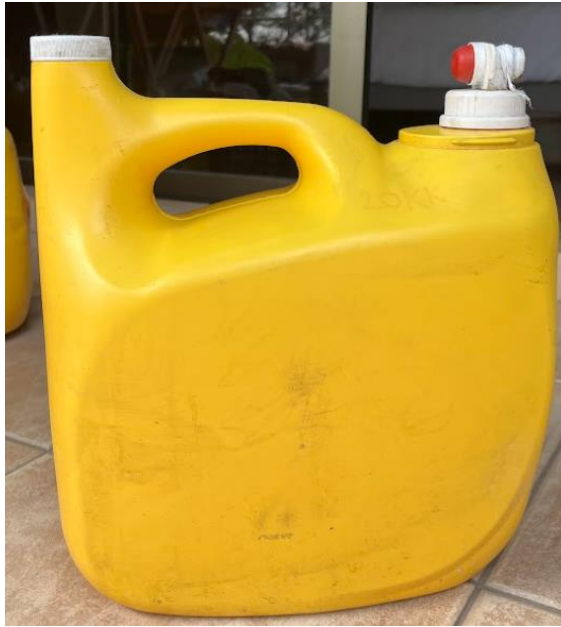
Figura 5: Recipiente de detergente utilizado como biodigestor
