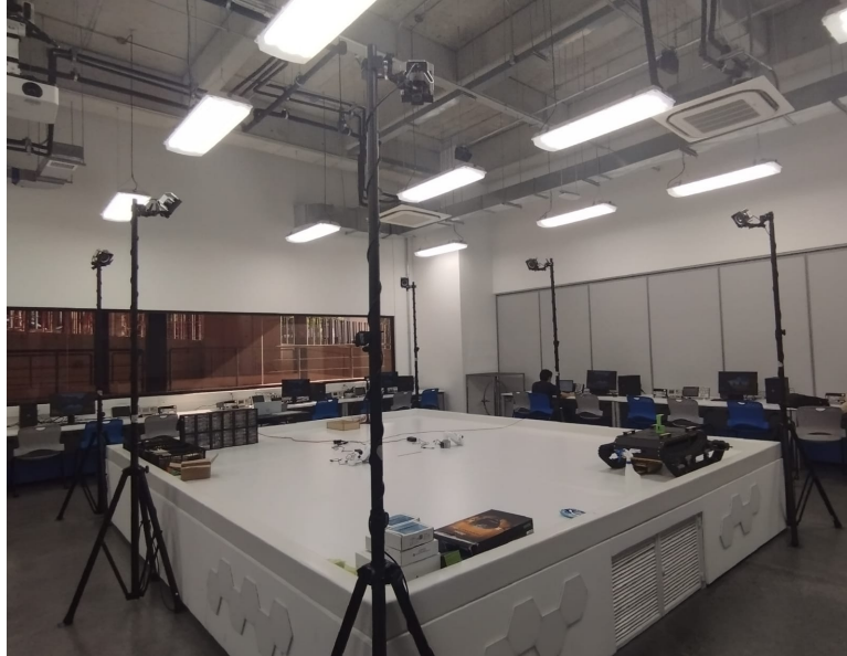
Figura 1: Ecosistema Robotat con cámaras de detección de movimiento OptiTrack.
