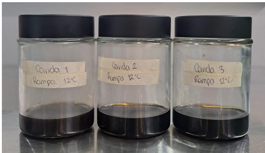
Figura 45. Combustible líquido obtenido de la pirólisis de aceite de motor usado empleando la rampa de aumentos de 12 °C con 30 minutos de residencia en el reactor
