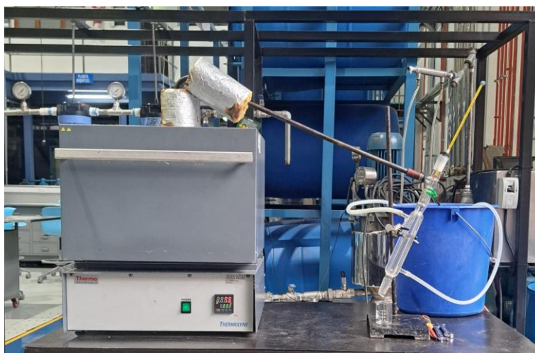
Figura 48. Montaje de reactor de pirólisis y condensador
