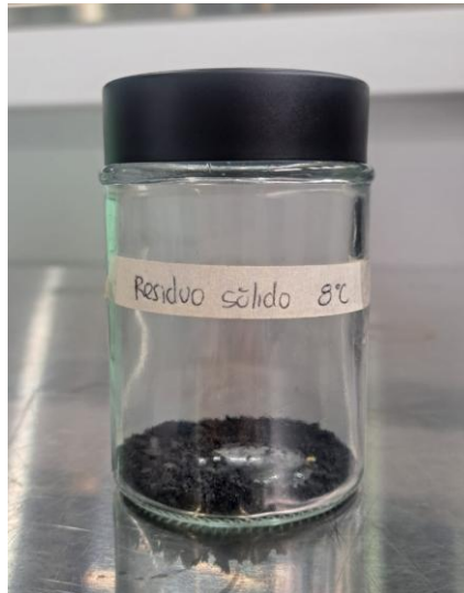
Figura 44. Char obtenido de la pirólisis de aceite de motor usado empleando la rampa de aumentos de 8 °C con 30 minutos de residencia en el reactor
