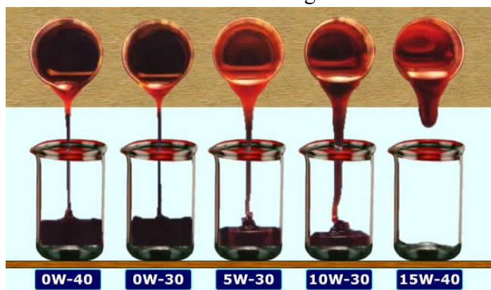
Figura 10. Comparación gráfica de la diferencia de viscosidad entre los diferentes aceites lubricantes multigrado
