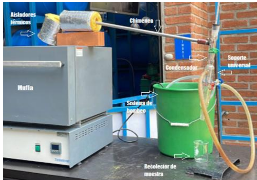
Figura 14. Montaje experimental para sistema de pirólisis
