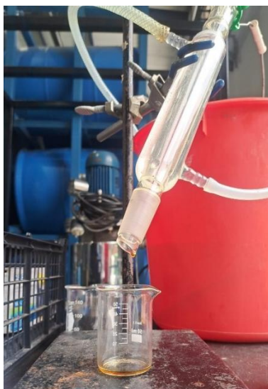
Figura 47. Recolección de combustible líquido de la pirólisis de aceite de motor usado
