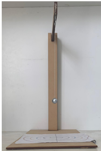
Figura 14.1: Vista frontal del péndulo esférico construido, con el conjunto 1 cuerda-esfera
