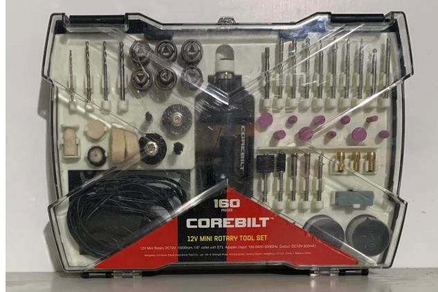
Figura 7.1: Multiherramienta rotativa (dremel) utilizada para hacer el corte en el brazo vertical y así colocar el horizontal
