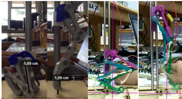
Figura 31: Comparación resultados de desplazamiento vertical primera fase vs segunda fase
