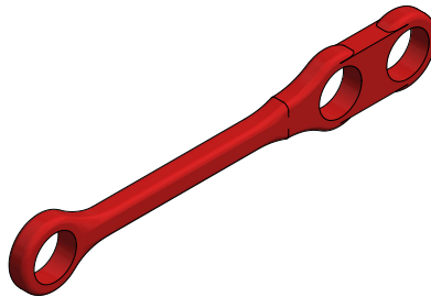
Figura 17: Eslabón rediseñado para evitar el uso de más rodamientos
