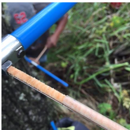
Figura 10. Método de extracción de las muestras en el tronco del árbol.
