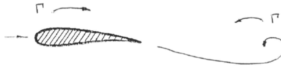
Figura 9. Circulación alrededor de un perfil sustentador. 9
