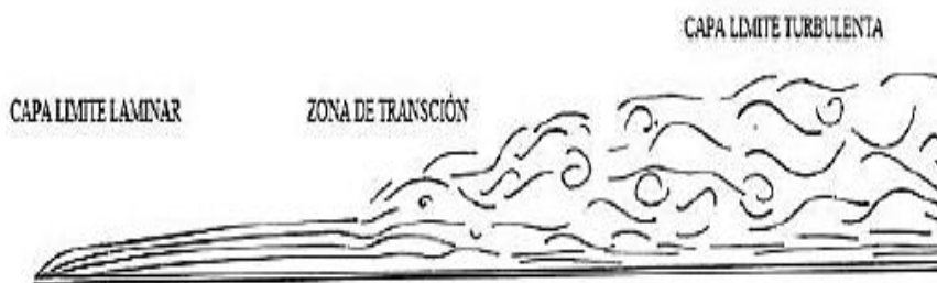
Figura 1. Transformación de capa límite 1
