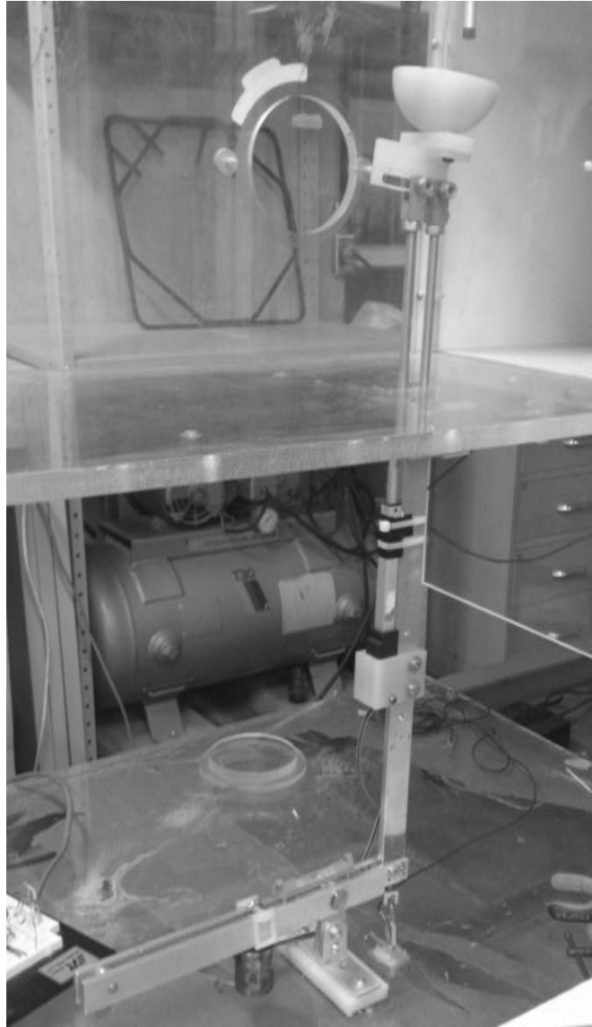
Figura 50. Sistema de balance de fuerzas
