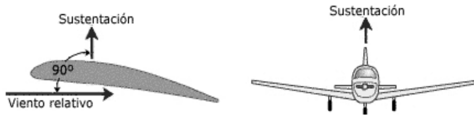
Figura 8. Dirección de fuerza de sustentación sobre un cuerpo 8
