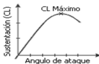
Figura 12. Coeficiente de sustentación vs. ángulo de ataque. 12
