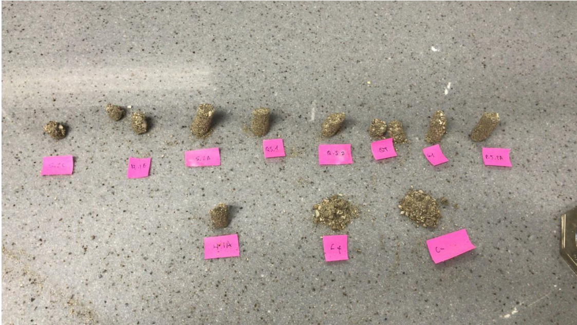
Figura No. 10: Prueba de adherencia de partículas de arena por medio de la biomineralización de carbonato de calcio.
