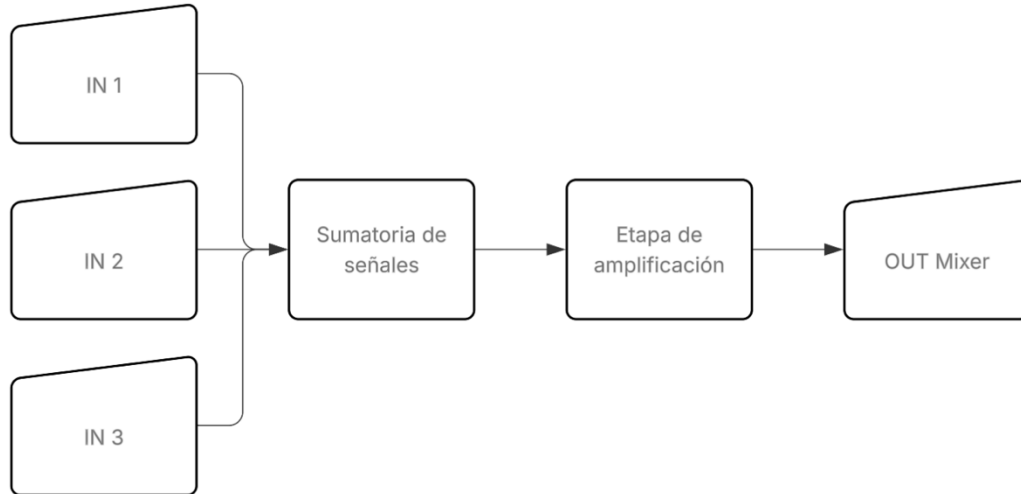
Figura 35. Diagrama de bloques mixer
