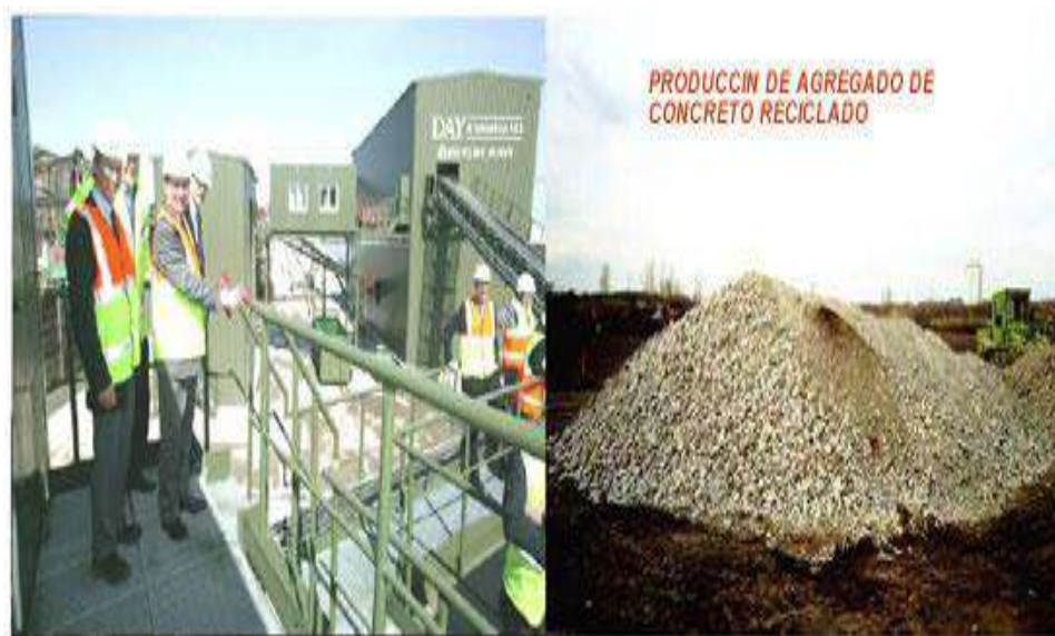
Ilustración 11. Producción de agregado de concreto reciclado
