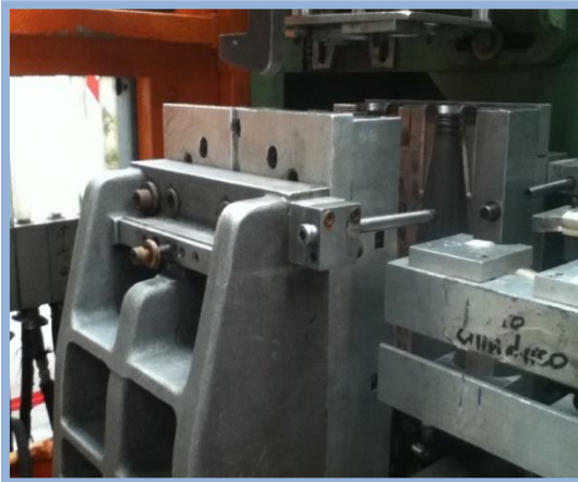
Ilustración 19: Ejemplo de molde instalado por encima del sujetador.
