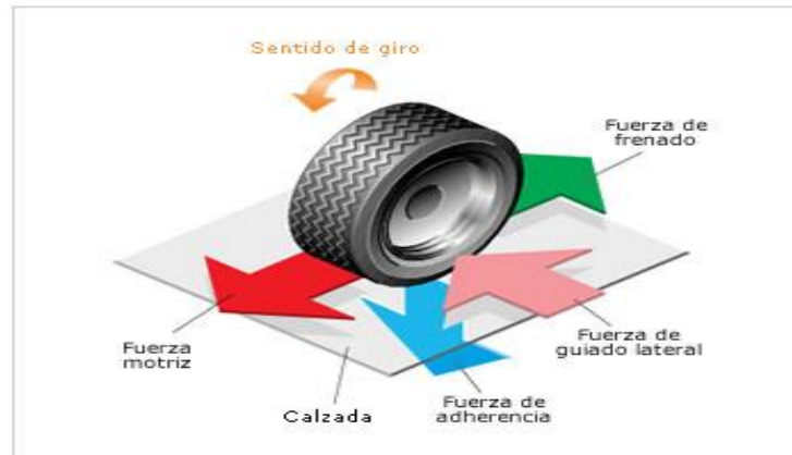
Figura 8. Diagrama de fuerzas que experimenta un neumático.
