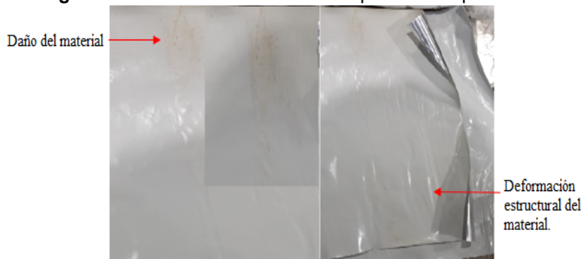
Figura 232. Daños en el material después de las pruebas.
