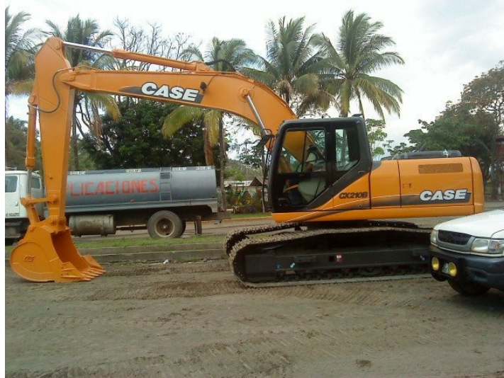
Ilustración 13. Excavadora de orugas CASE modelo CX210B.
