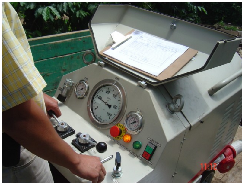
Figura No. 16: central hidráulica que se debe utilizar para accionar los gatos hidráulicos para el reforzamiento de estructuras con postensado externo
