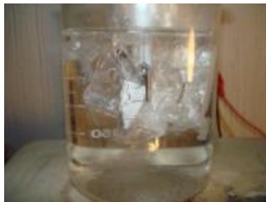
Figura 107: Colocación de los sensores de temperatura (tipo C y M) en el sistema
