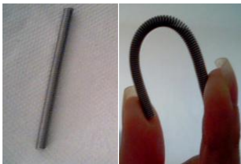
Figura 63: Resorte helicoidal para la extensión
