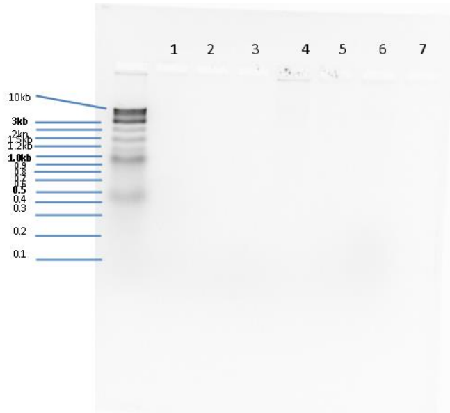
Figura 18A. Gel de PCR 2% iniciadores SNP 2(8471_72). Tm 52°C.
