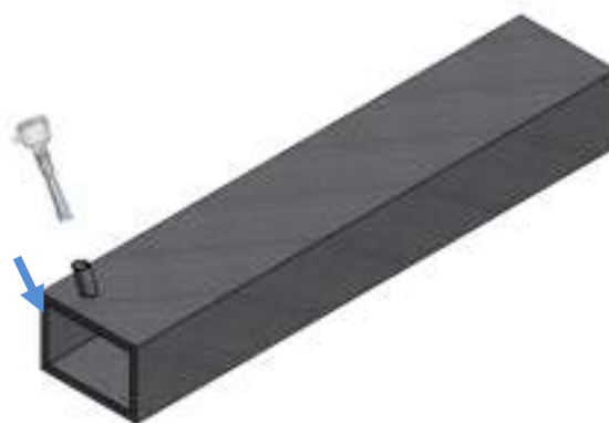
Figura 17, Instalación del sensor de nivel
