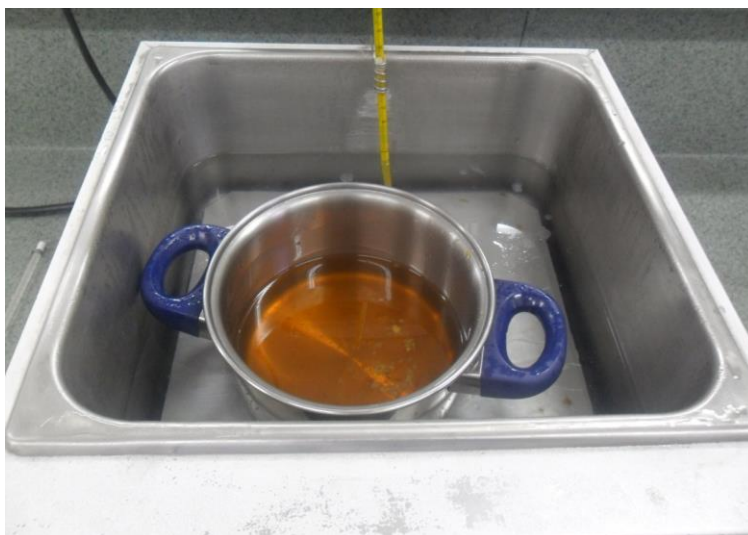
Foto 2: Vista por dentro del equipo utilizado para balance de energía de baño maría experimental
