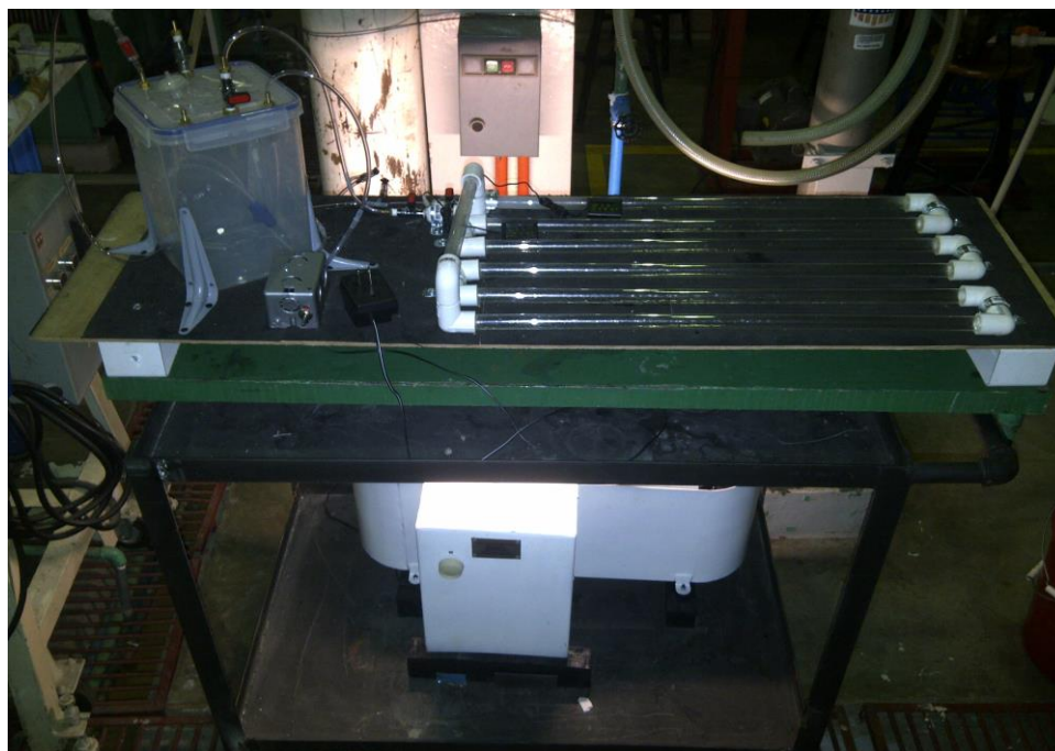
Fotografía No. 6 Fotobiorreactor tubular previo a la instalación del sistema de iluminación, instalado en el Laboratorio de Operaciones Unitarias de la Universidad del Valle de Guatemala.
