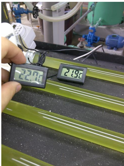
Fotografía No. 4: Adición del medio al fotobio reactor tubular de 5 L instalado en Laboratorio de Operaciones Unitarias de la Universidad del Valle de Guatemala
