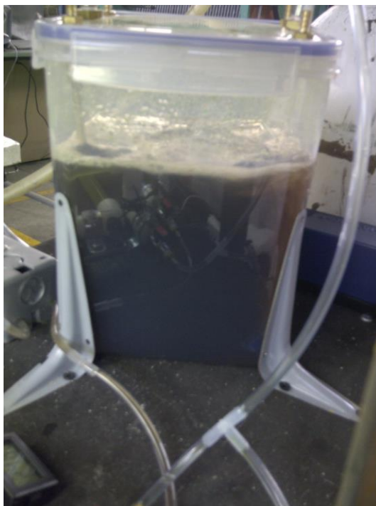
Fotografía No. 6 Fotobiorreactor tubular previo a la instalación del sistema de iluminación, instalado en el Laboratorio de Operaciones Unitarias de la Universidad del Valle de Guatemala.
