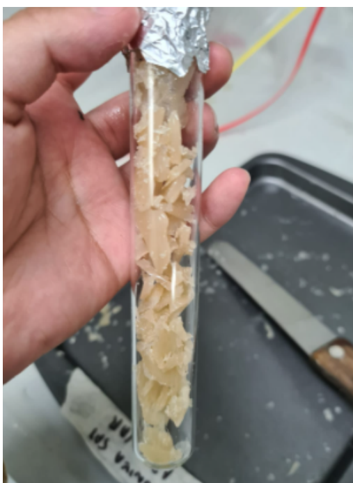
Figura 50. Polímero formado luego de una reacción de polimerización en catálisis metálica luego de 8 horas a 170°C y 0.2% v/v de octoato de estaño
