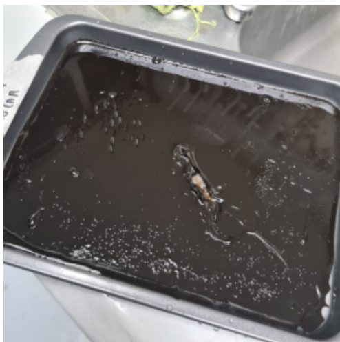
Figura 51. Polímero formado luego de una reacción de polimerización en catálisis metálica luego de 8 horas a 170°C y 10% v/v de octoato de estaño
