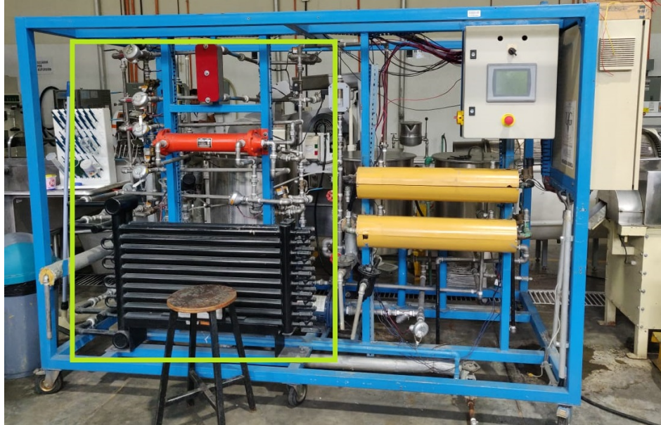
Figura 42: Montaje de los tres intercambiadores de calor instalados.
