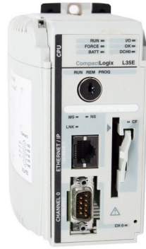
Figura 14: Controlador lógico programable Allen Bradley 1769-L35E.
