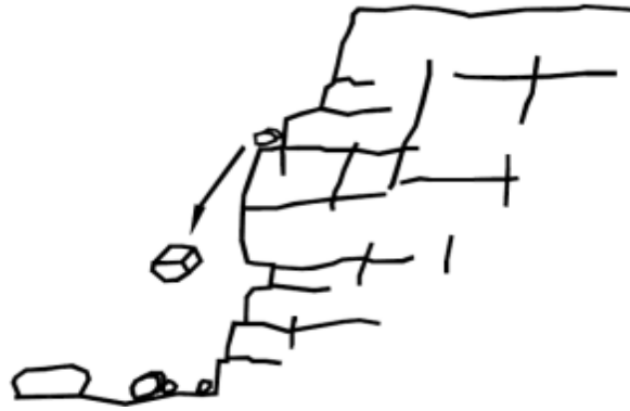
Figura 29 Caída de bloques
