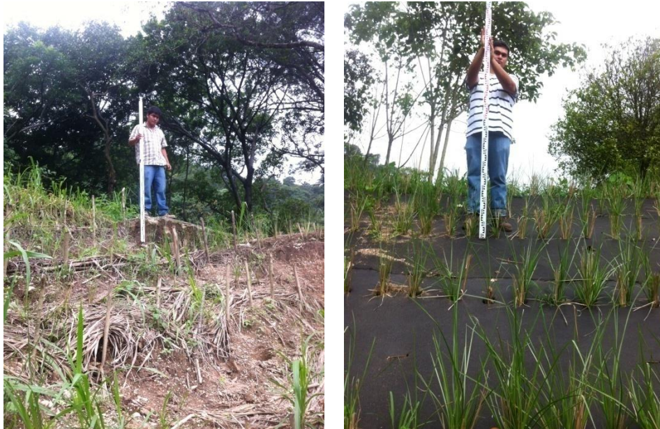
Imagen 49 Sujetando el estadal para realizar las mediciones
