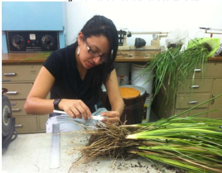
Imagen 90 Medición del diámetro de las raíces
