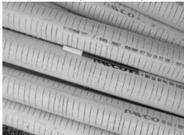
Imagen 30 Ranuras para subdrenes de penetración
