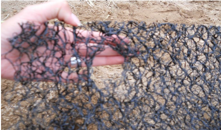
Imagen 62 Hoyo en la Geomanta utilizada
