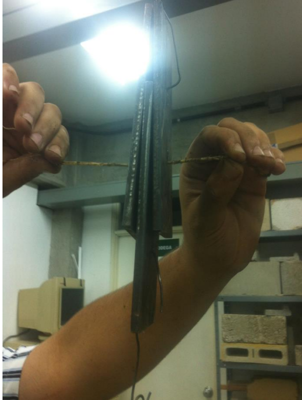
Imagen 93 Ensayo a corte de la raíz del Vetiver
