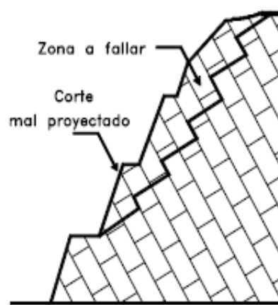
Figura 44 Desmoronamiento de un talud o falla en escalera generado por un volteo
