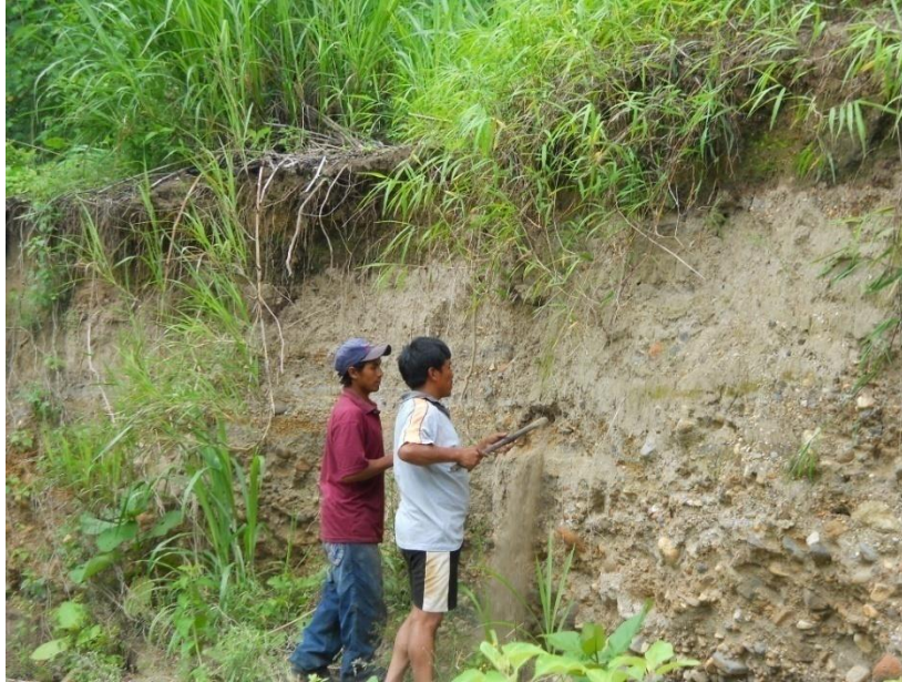
Imagen 43 Tallado del cilindro
