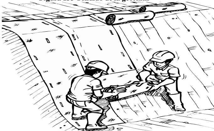
Figura 133 Tendido de la geotextil
