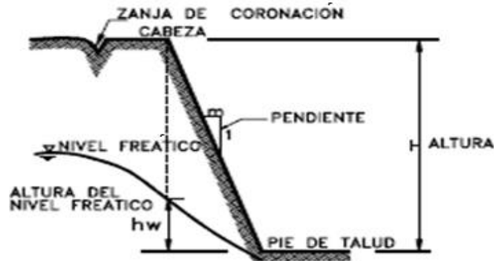
Figura 21 Talud artificial, corte o relleno
