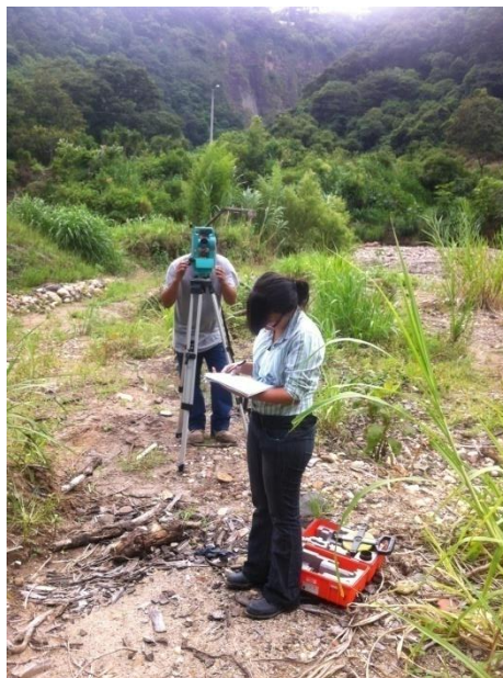
Imagen 48 Mediciones de ángulo e hilos con teodolito. Registro de datos.
