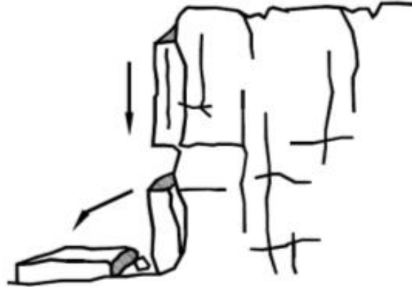
Figura 28 Inclinación y caída de losas
